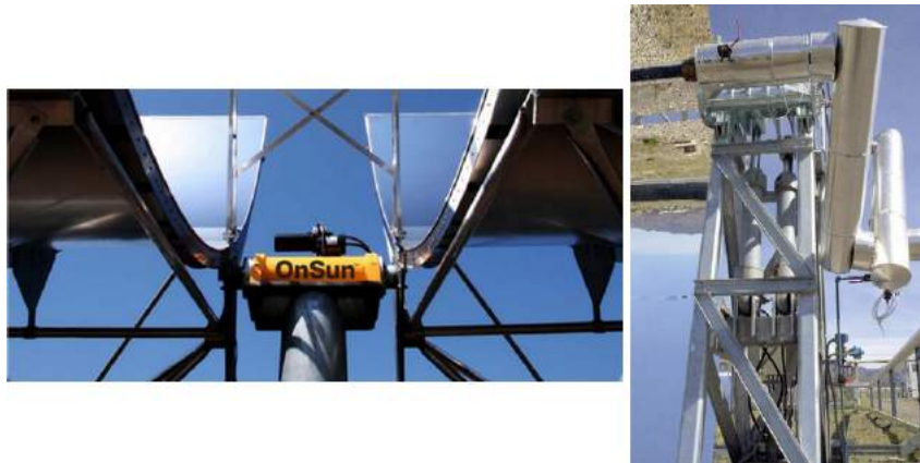
Figura 20: Esquerda: Sistema da Skyfuel que utiliza um atuador rotativo hidráulico; Direita: Sistema de atuação de duplo cilindros hidráulicos
