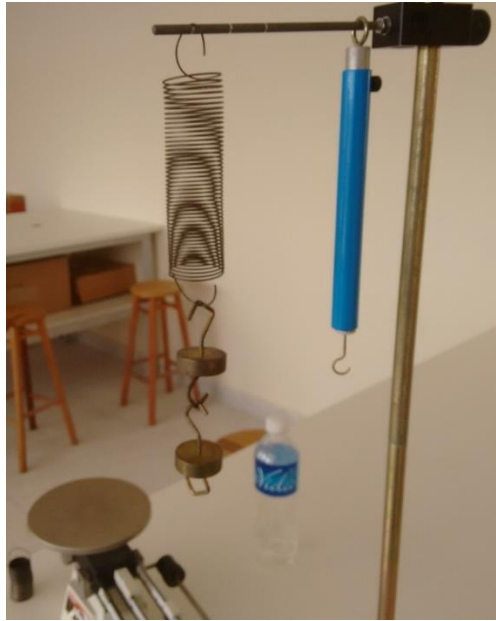
Figura 46 - Ensaio da deformação da mola utilizando dois corpos de massa de 51,4 gramas cada.
