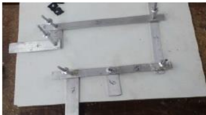
Figura 43 - Vigas Unidas por meio dos pivôs.
