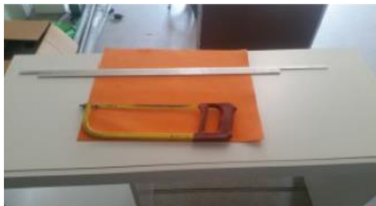
Figura 40 - Serra de arco utilizada para o corte das barras.
