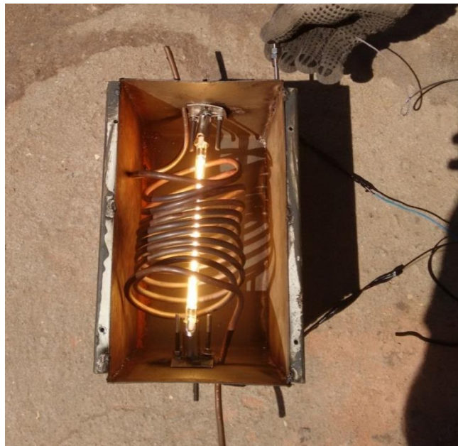
Figura 57 - Medição de temperatura na face exterior da caixa com o auxílio de um termopar.
