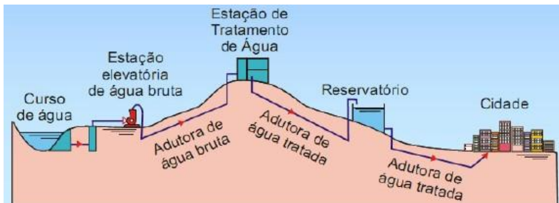
Figura 3. Esquema geral do Sistema de Abastecimento de Água. Fonte: Alegre et al. (2000) apud Tsutiya (2006).
