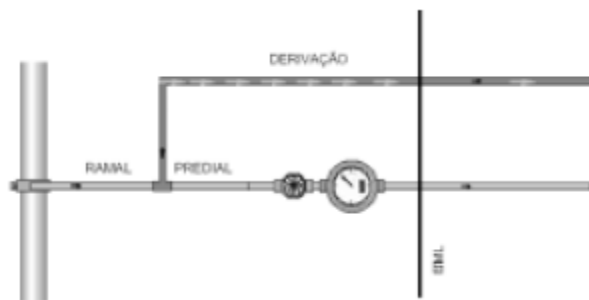
Figura 7. Tipo de ligação ilegal de abastecimento de água: derivação de ramal.
