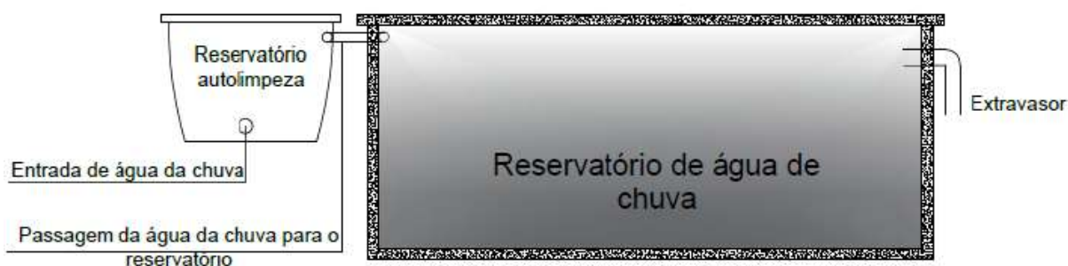
Figura 5 – Sistema de armazenamento de água de chuva com reservatório de autolimpeza
