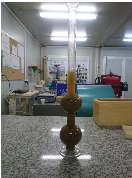
Figura 26 - Ensaio de determinação de massa específica da areia natural.
