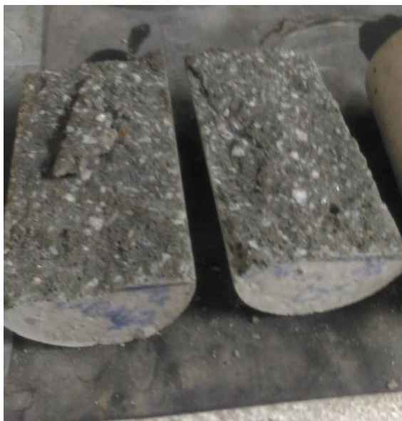
Figura 41 - Concreto simples, T0, rompido a compressão diametral.
