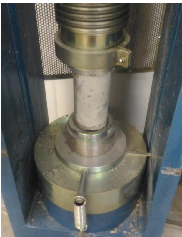
Figura 36 - Corpos de prova dispostos na prensa hidráulica para compressão axial.
