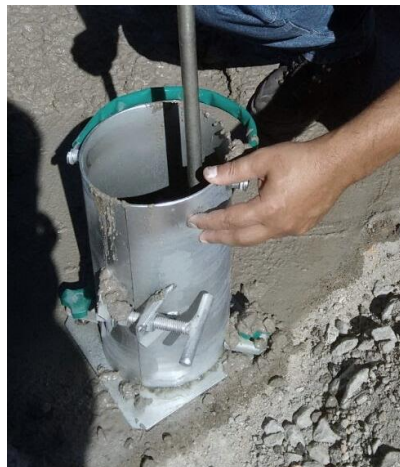
Figura 35 - Representação de adensamento de corpos de prova testes.
