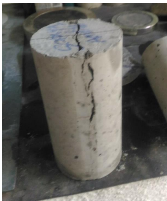
Figura 42 - Concreto com fibras de aço, T1, rompido a compressão diametral.
