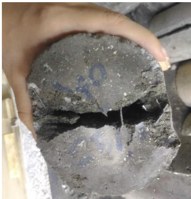
Figura 43 - Concreto do traço T2 após rompimento à compressão diametral.
