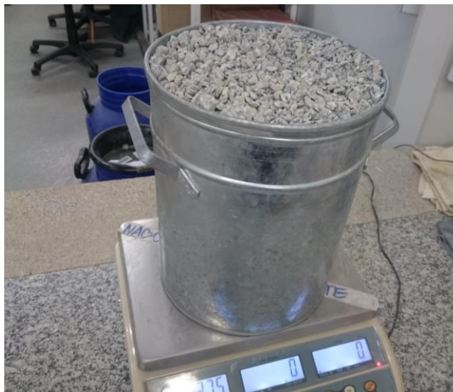
Figura 29 - Ensaio de Massa unitária compactada do agregado graúdo.
