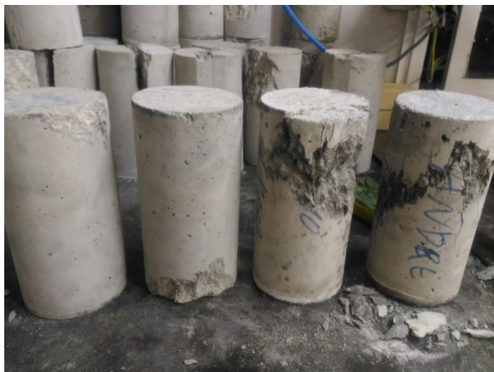
Figura 39 - Dois corpos de prova do traço T1 à esquerda, e os dois outros do traço T2, todos rompidos à compressão axial.
