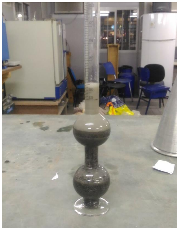
Figura 27 - Ensaio de determinação da massa específica da areia de brita.
