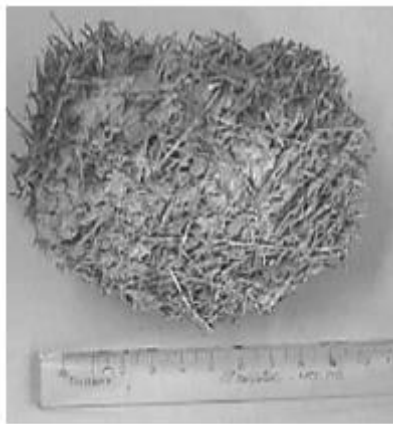
Figura 10 - Ourião de fibras de aço formado na mistura do concreto (Fonte: Figueiredo, 2000).
