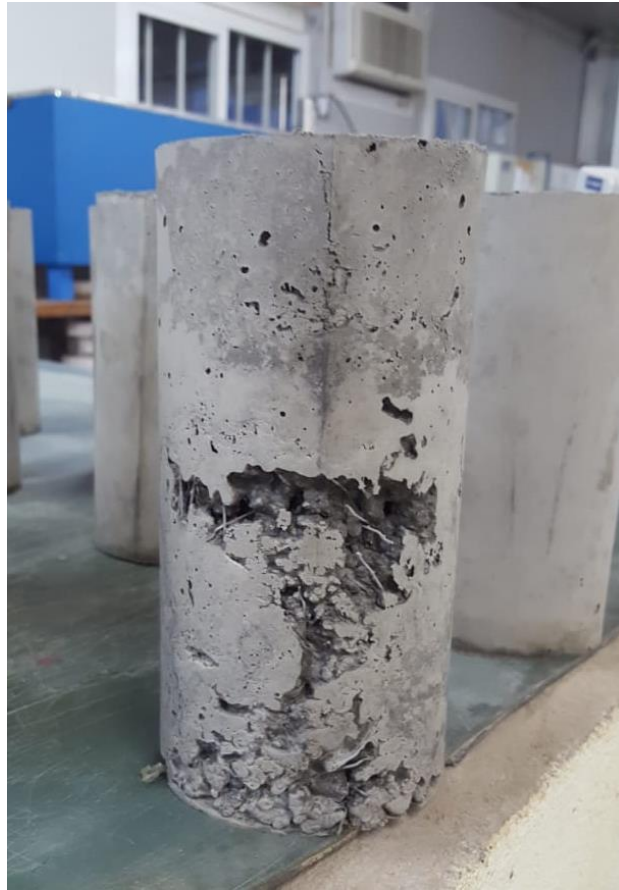
Figura 38 - Corpo de prova contendo pontos de fragilidade.
