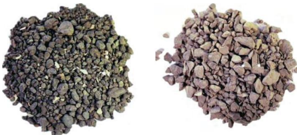
Figura 16 - Comparação entre o formato de areia natural (primeira) e areia de brita (segunda) (Fonte: Coin, 2009 apud André, 2017).
