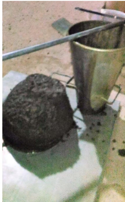
Figura 34 - Ensaio de abatimento de cone.
