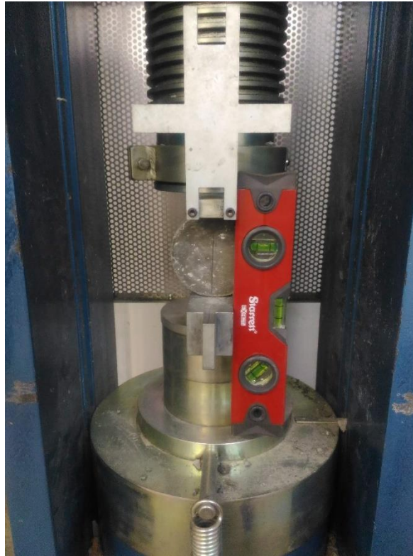
Figura 37 - Corpo de prova disposto para ensaio à compressão diametral.
