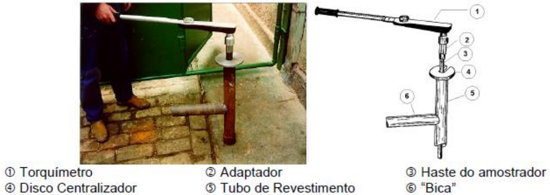
Figura 2.15 – Composição de equipamentos para realização da medição do torque Peixoto(2001, apud Alonso, 1994) .
