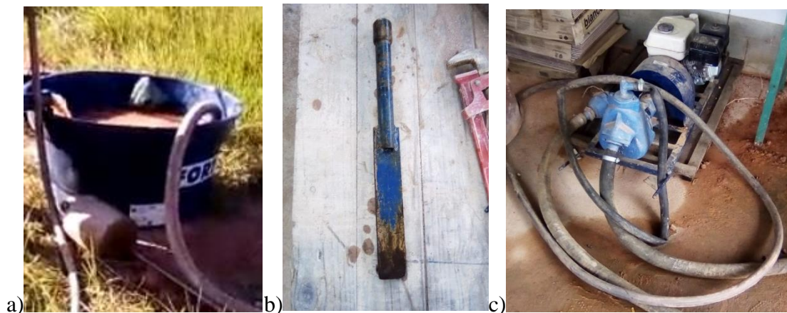
Figura 3.7 – a) Caixa d'água b) Trépano de lavagem. c) Bomba d'água centrífuga motorizada.
