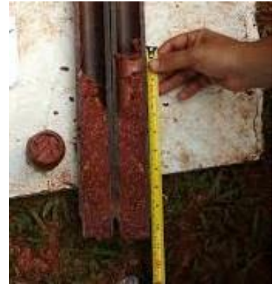
Figura 2.8 – a) Foto mostrando levantamento do martelo que será solto no conjunto amostrador-haste-cabeça de bater. b) Análise tátil visual do material retido no amostrador.
