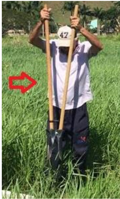
Figura 2.3 – a) Figura de uma cavadeira articulada boca de lobo e b) Figura do conjunto com (1) Trado helicoidal manual (2) Luva de 1'; (3) Haste metálica de 1'; (4) Chave de grifo; (5) Cruzeta de 1'.
