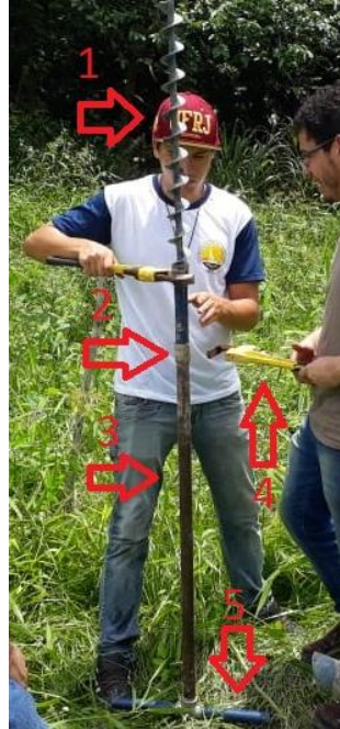
Figura 2.3 – a) Figura de uma cavadeira articulada boca de lobo e b) Figura do conjunto com (1) Trado helicoidal manual (2) Luva de 1'; (3) Haste metálica de 1'; (4) Chave de grifo; (5) Cruzeta de 1'.
