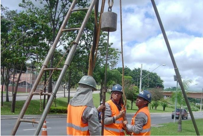
Figura 2.8 – a) Foto mostrando levantamento do martelo que será solto no conjunto amostrador-haste-cabeça de bater. b) Análise tátil visual do material retido no amostrador.
