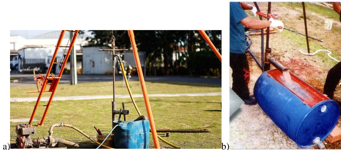
Figura 2.10 – a) Trépano conectado ao conjunto de hastes e à bomba hidráulica. b) Conjunto com trépano e bomba expelindo água do furo.
