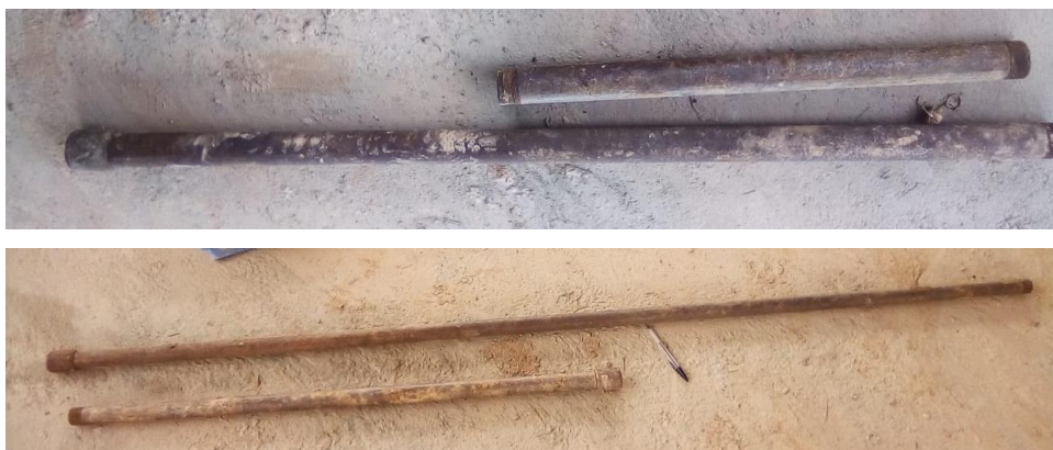
Figura 3.5 – Tubo de revestimento e hastes de perfuração
