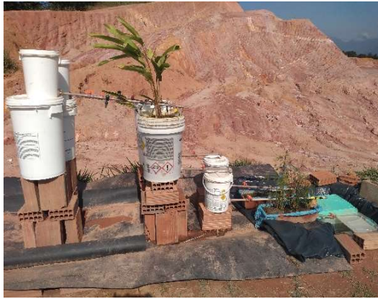
Figura 20. Sistema de tratamento com os WCs e sistema de controle. (Foto da autora, 2019)
