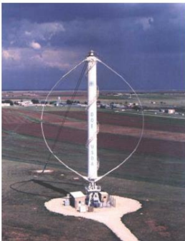
Figura 1.13 – Aerogeradores de eixo vertical, Bushland, Texas; SANDIA (2000) apud DUTRA (2001).
