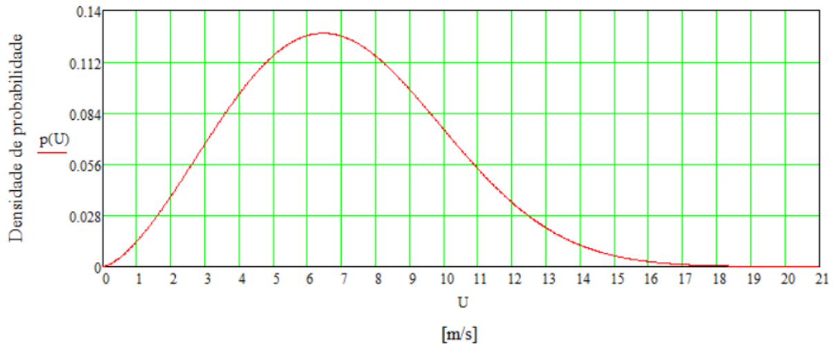
Figura 3.1 – Função densidade de probabilidade de Weibull para a velocidade média anual do vento a 15 m.
