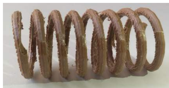
Figura 23 – impressão 3D de uma mola gerada pelo EleMAQ .
