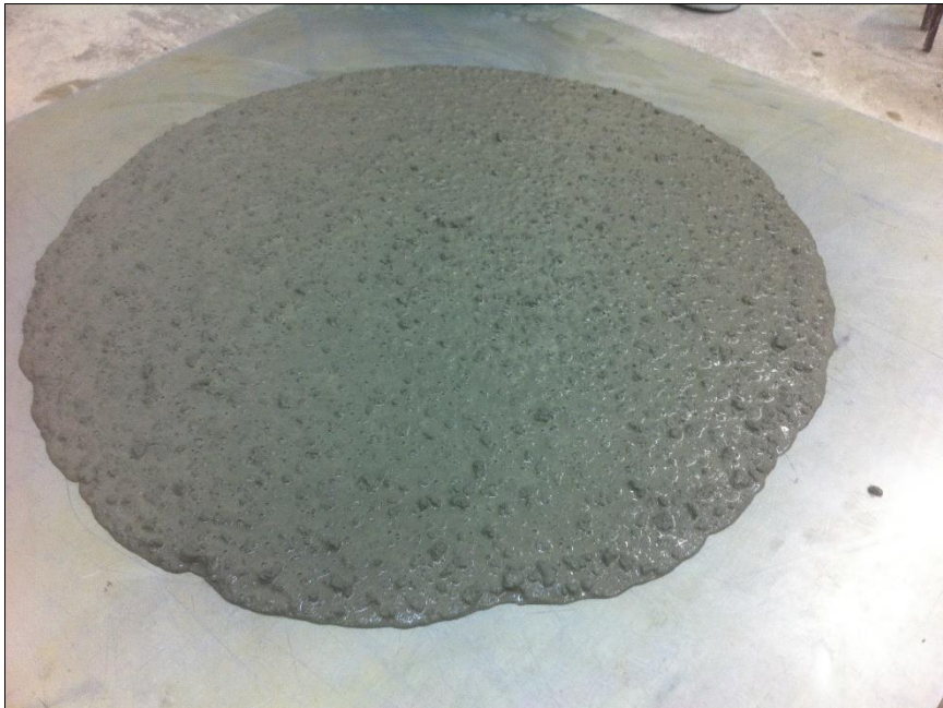
Figura 29 - Espalhamento do concreto após o ensaio de Slump Flow.
