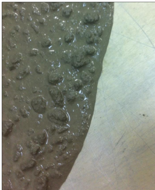
Figura 25 - Aspecto da borda após o ensaio anel J.
