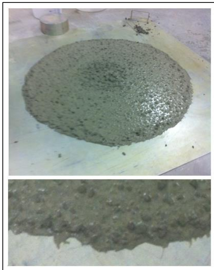
Figura 5 - Concreto com segregação e exsudação aparente.
