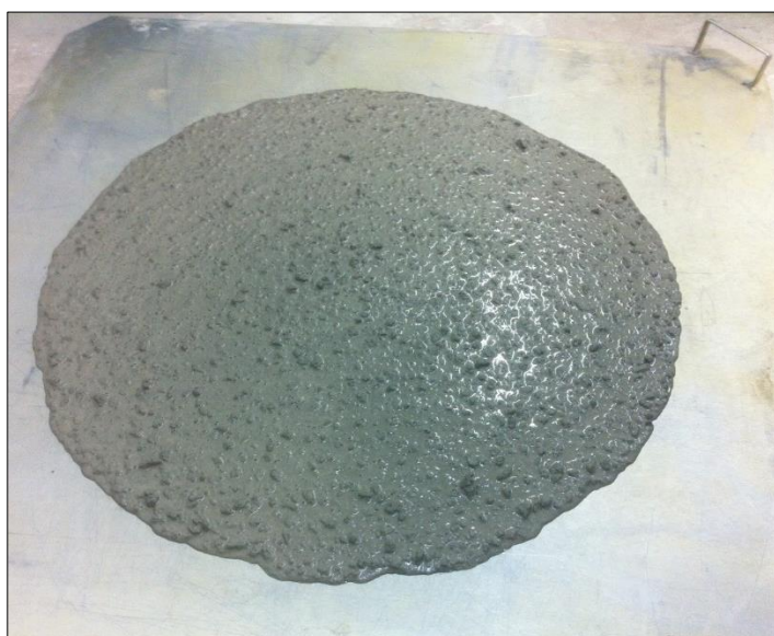
Figura 23 - Ensaio de espalhamento (Slump Flow).
