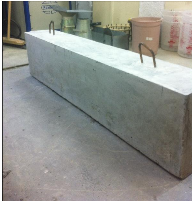
Figura 31 - Detalhe viga desformada.
