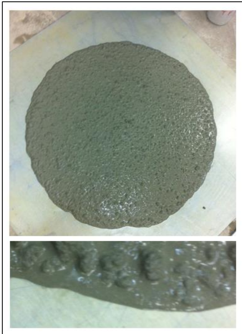
Figura 6 - Concreto sem segregação e exsudação aparente
