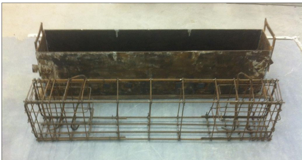
Figura 27 - Detalhe lateral da armadura e fôrma da viga utilizadas para teste.
