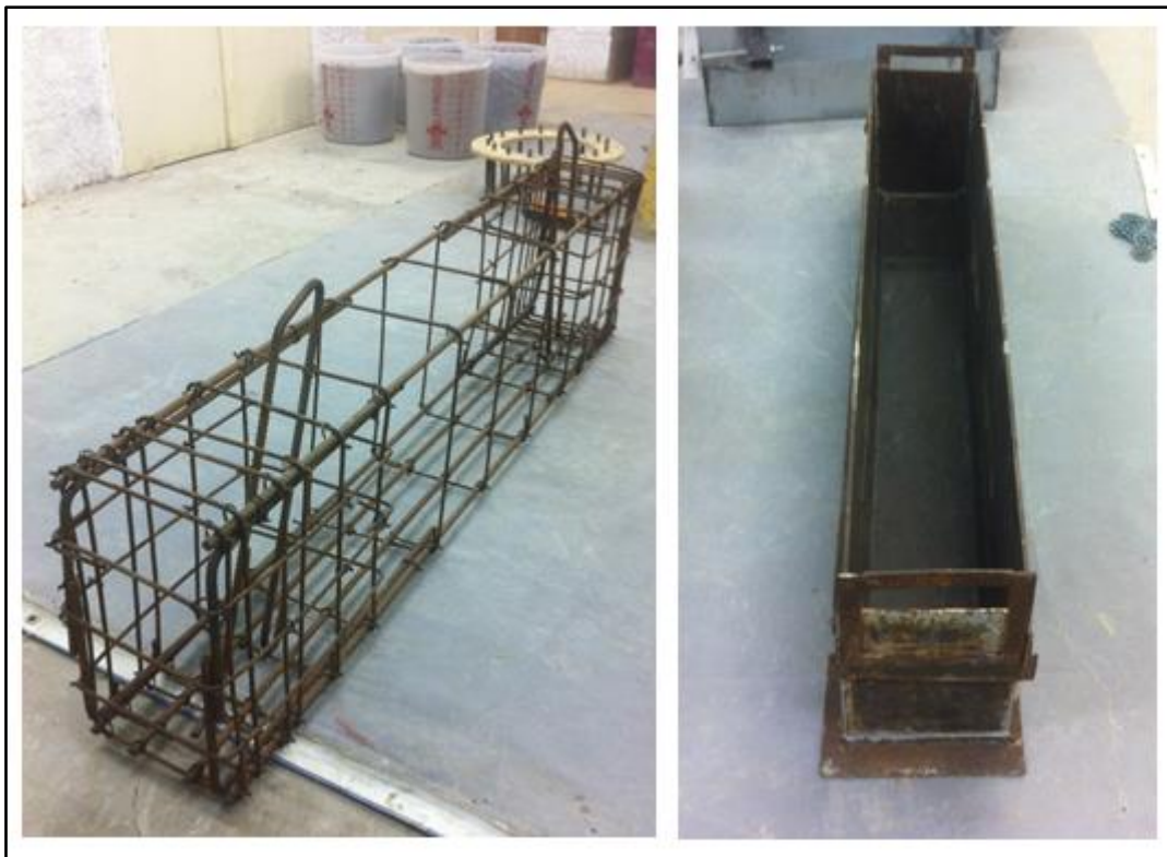
Figura 26 - Detalhe armadura e fôrma da viga.
