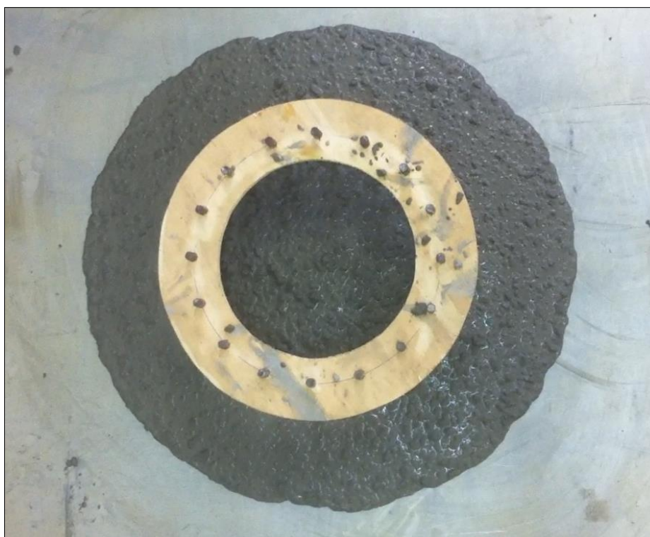
Figura 9 - Ensaio Anel J.
