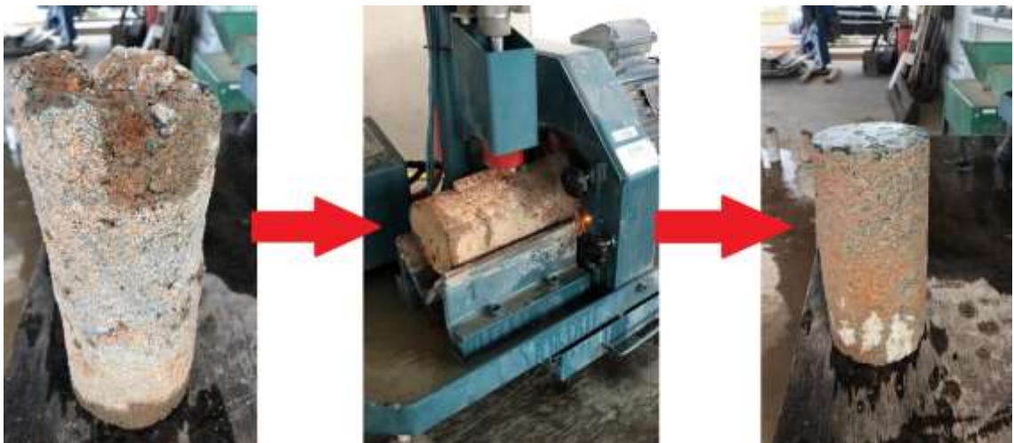
Figura 5.10 – Corpo de prova que foi curado no solo no processo de retificação
