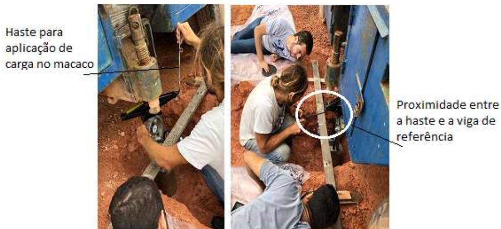
Figura 4.44 – Aplicação de carga com macaco mecânico na placa de 14 cm.
