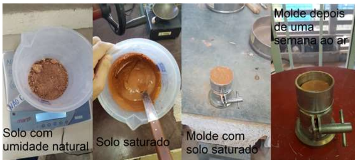
Figura 4.19 – Experimento realizado para demonstrar a expansão da argila quando em contato com água.
