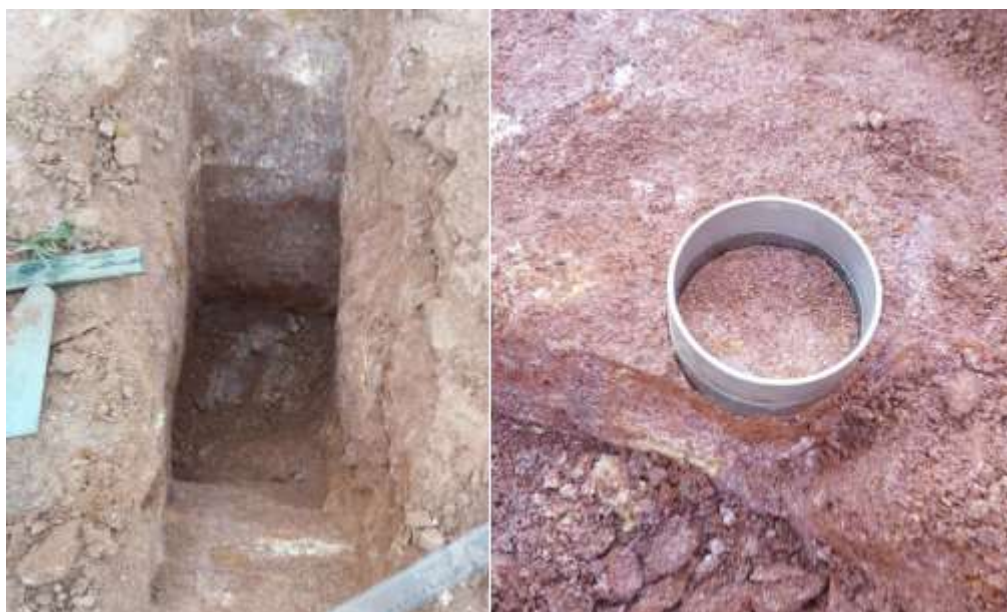
Figura 4.14 – Cava para retirada da amostra a 50 cm de profundidade e anel sendo cravado na superfície.
