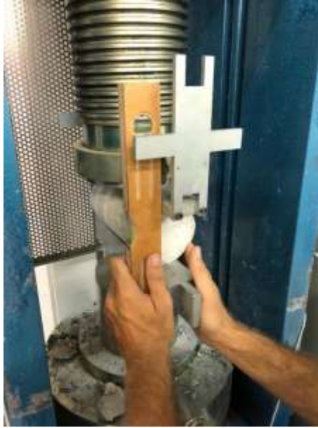
Figura 4.26 – Corpo de prova sendo conformado para o ensaio
