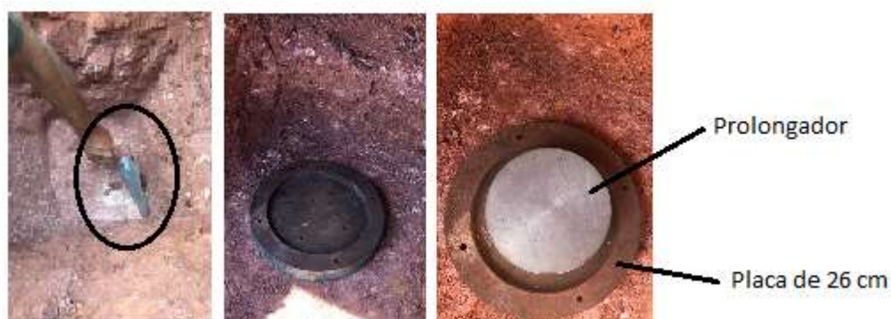
Figura 4.39 – Sequência da instalação da placa de diâmetro de 26 cm.
