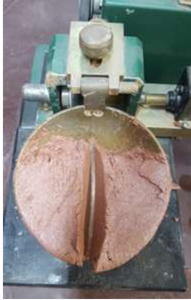
Figura 4.11 – Detalhe da ranhura executada na amostra.
