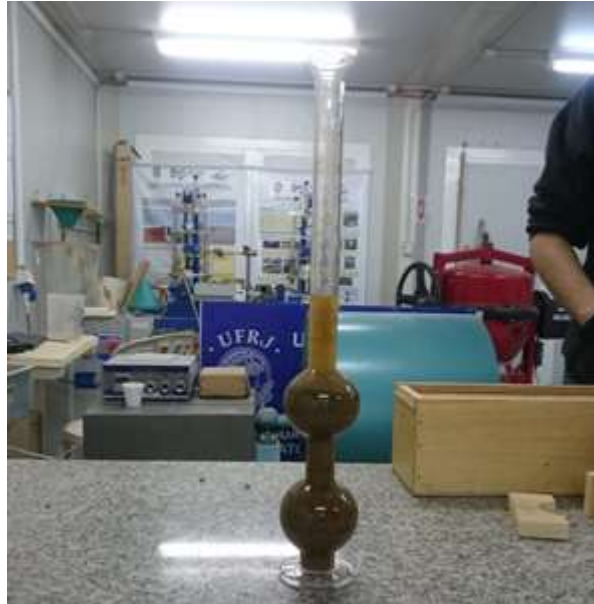
Figura 4.21 – Execução do ensaio do frasco de Chapman.
