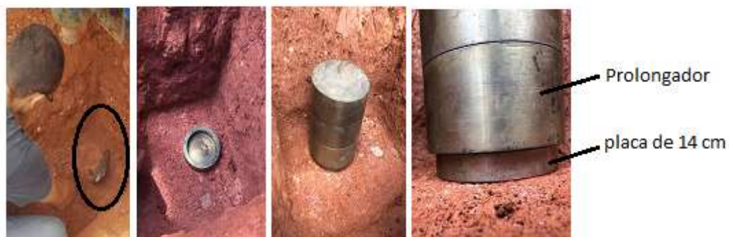
Figura 4.38 – Sequência da instalação da placa de diâmetro de 14 cm.
