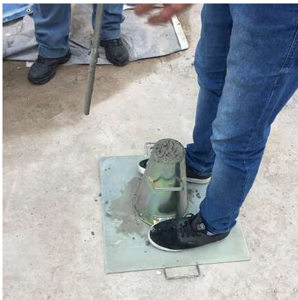
Figura 4.23 – Execução do ensaio de abatimento.
