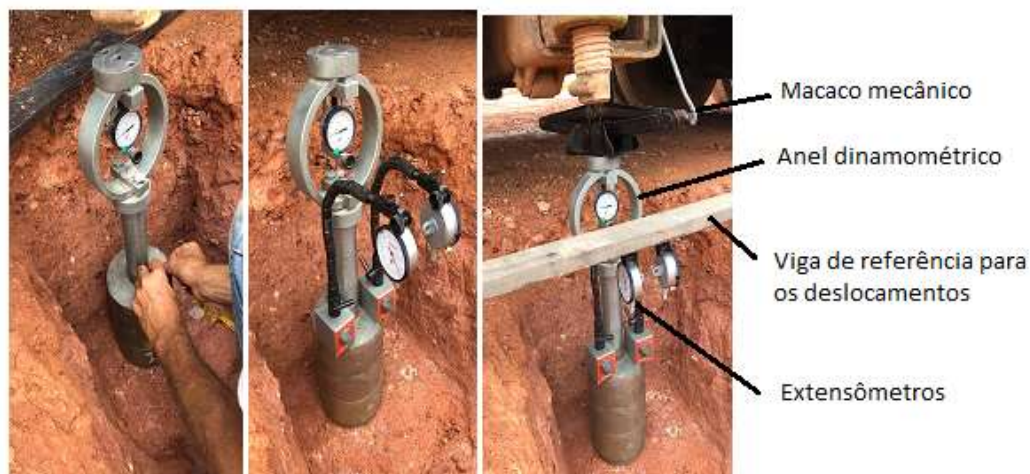
Figura 4.40 – Sequência da instalação dos sistemas de medição e aplicação de carga e deslocamentos para a placa de 14 cm de diâmetro.
