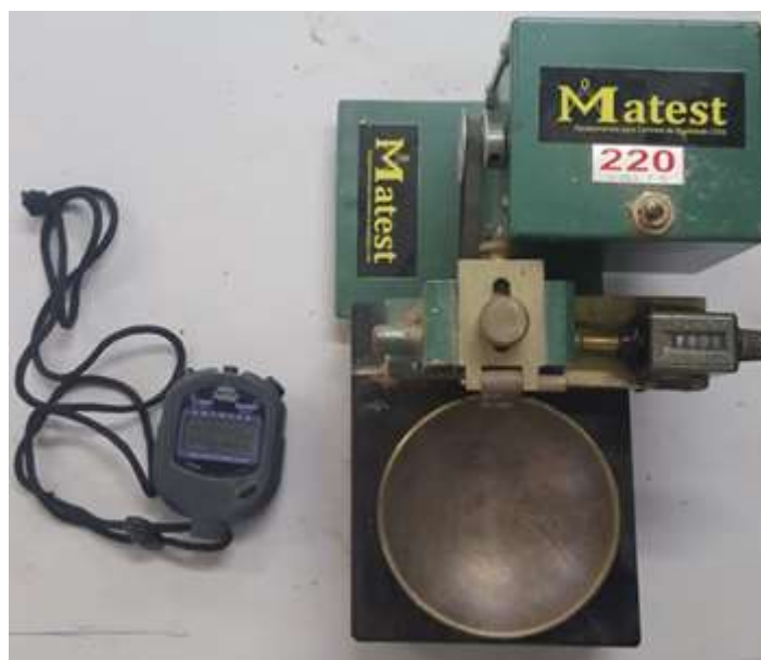
Figura A.4 – Aparelho de Casagrande durante a calibração
