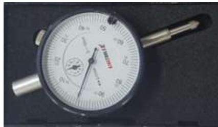
Figura 4.35 – Extensômetro utilizado para medida dos recalques.
