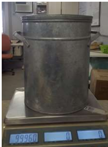
Figura A.3 – Balde de aço durante a calibração
