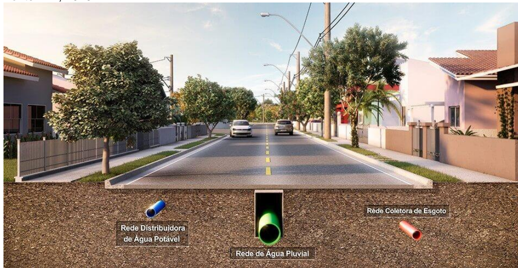
Figura 3: Tubulações que estão dentro do saneamento básico
