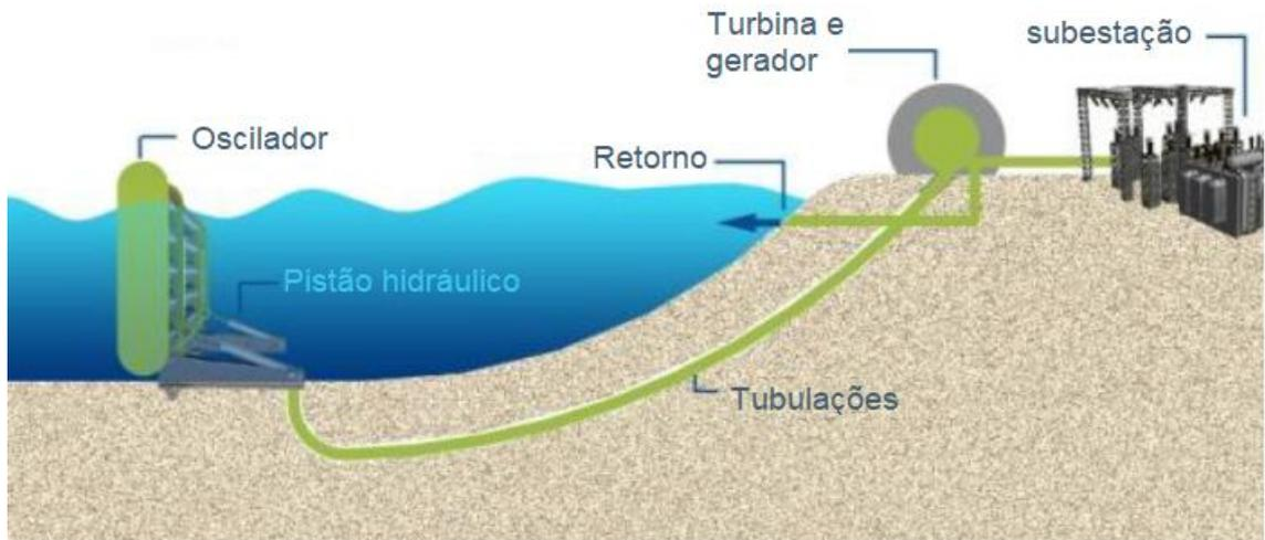
**Figura 49** – Ilustração do sistema de conversão de energia do dispositivo Oyster
