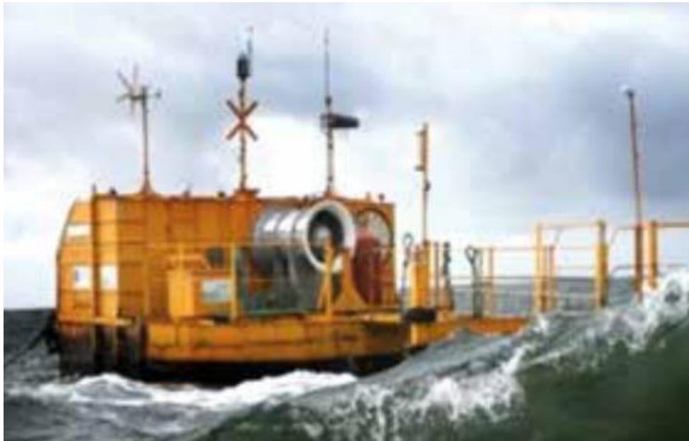
**Figura 47** – Protótipo do OE Buoy sendo testado.
