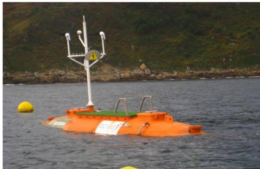
**Figura 37** – Protótipo do dispositivo Oceantec sendo testado.
