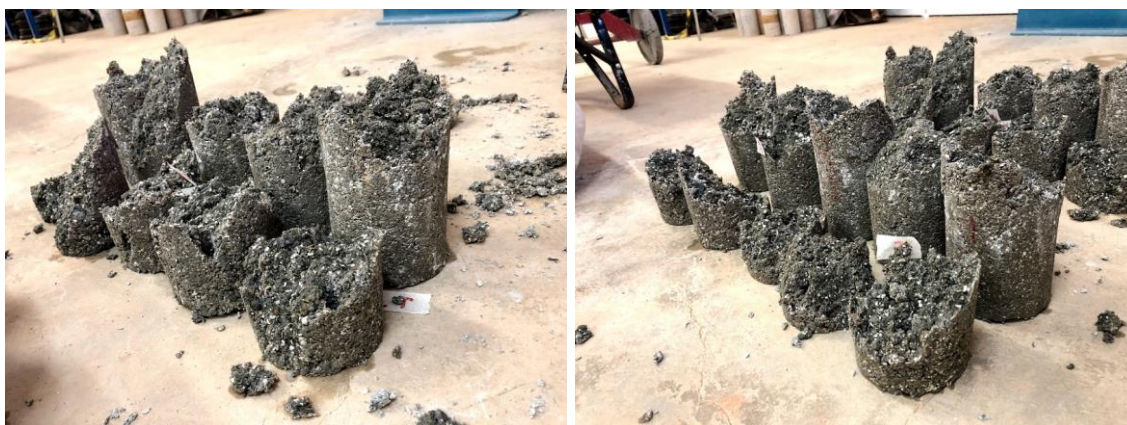
Figura 42: Corpos de prova rompidos acima do centro de gravidade
