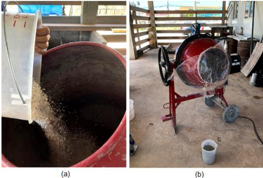
Figura 27: (a) Colocação do RPS na betoneira; (b) Betoneira com proteção de plástico
