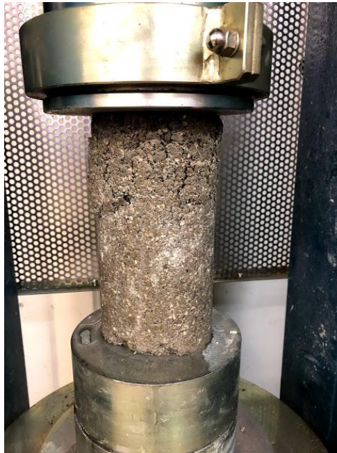
Figura 34: Corpo de prova após a ruptura
