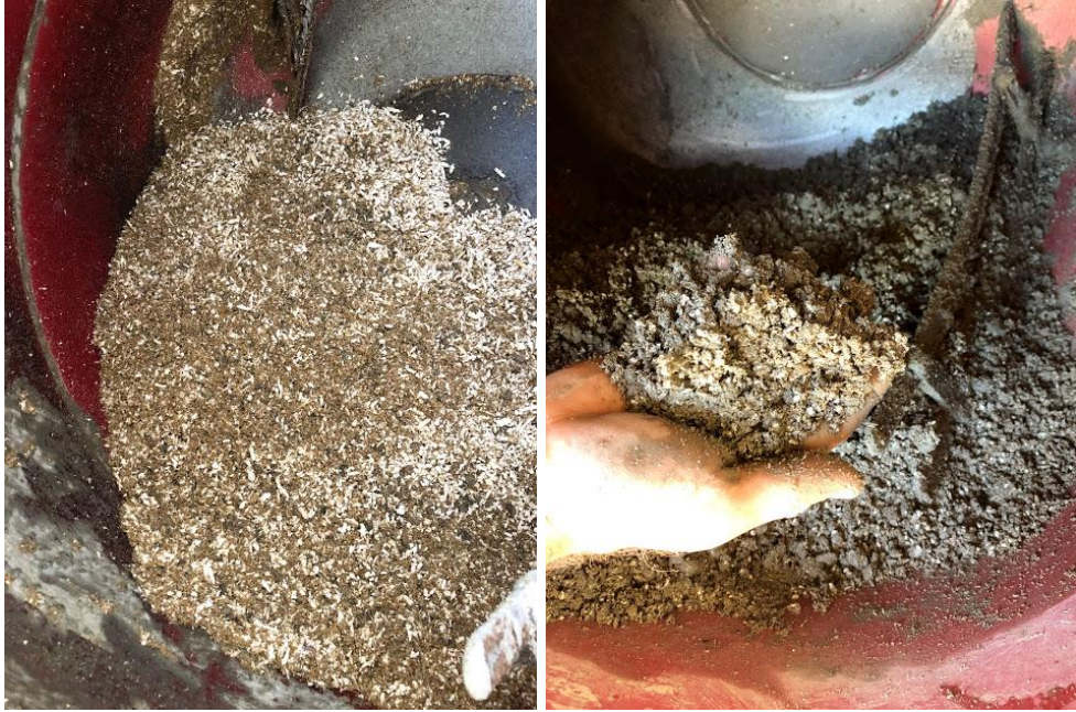
Figura 28: Concreto no estado de “farofa” e oncreto com aspecto mais pastoso
