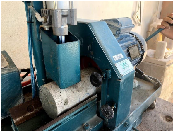
Figura 32: Retificadora com disco rotativo diamantado
