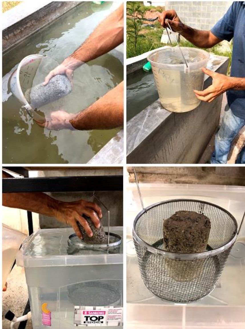
Figura 35: Sequencia que mostra o transporte dos corpos de prova do tanque para a balança hidrostática com ajuda de um balde
