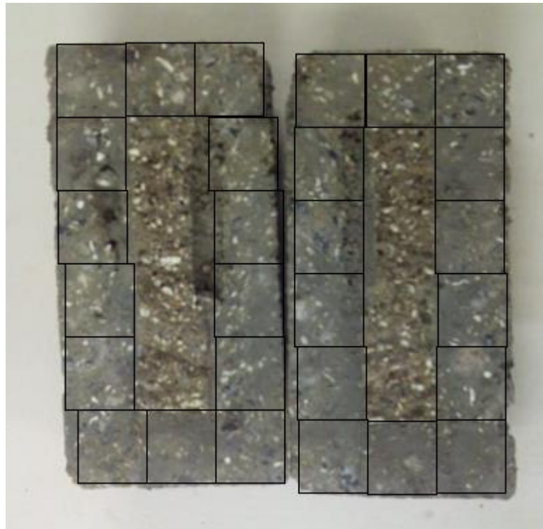
Figura 44: Segregação do RPS no corpo de prova
