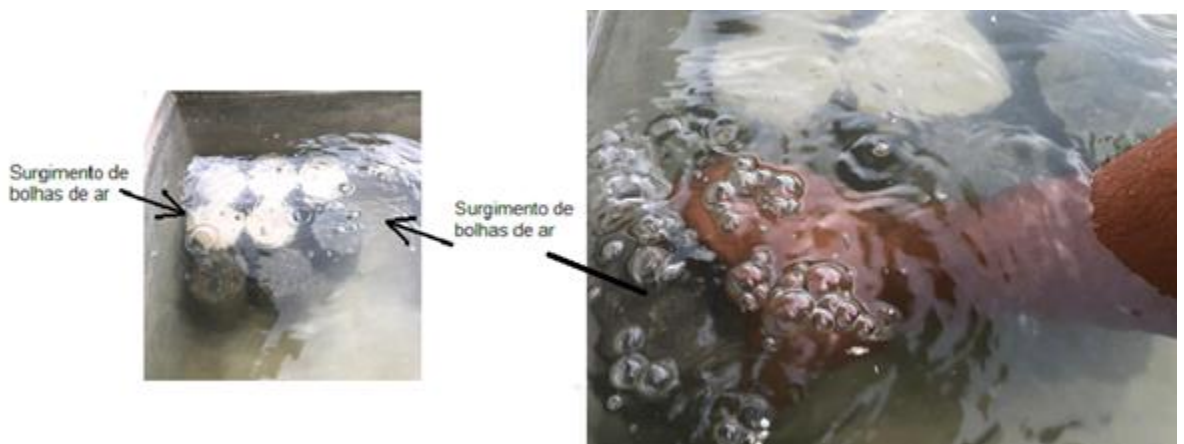
Figura 31: Corpo de prova dentro do tanque de cura
