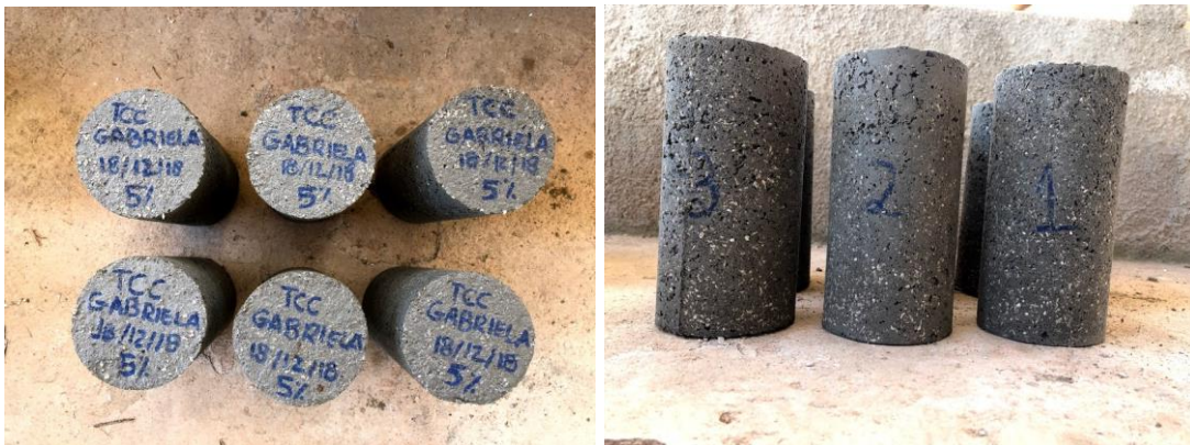
Figura 30: Corpo de prova do SURFE 3 desmoldados após 24 horas e identificados
