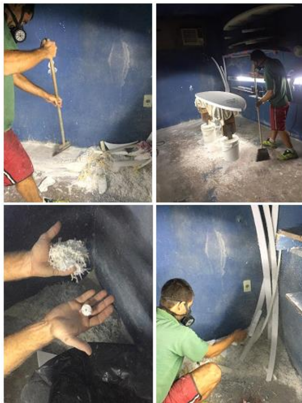
Figura 19: Sequência de coleta inicial do RPS na fábrica de pranchas
