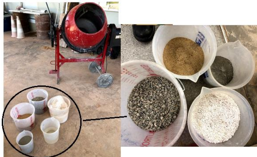
Figura 25: Betoneira de 150 L e Materiais do traço pesado
