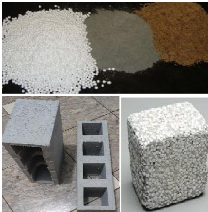
Figura 14: Matérias primas do concreto leve com EPS e alguns exemplos de aplicação. Fonte: JUNOEPSR (acesso em 05 de fevereiro de 2019)
