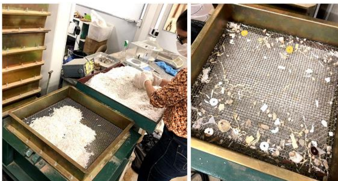
(a) RPS sendo colocado na peneira de abertura 6,35mm; (b) Material retido após a peneiração
