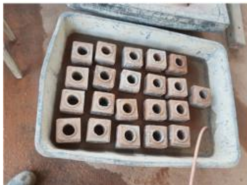
Figura 31: Imersão dos corpos de prova
