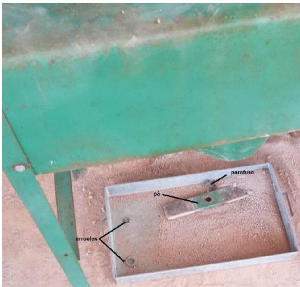
Figura 48: Peças do destorroador desmontado.
