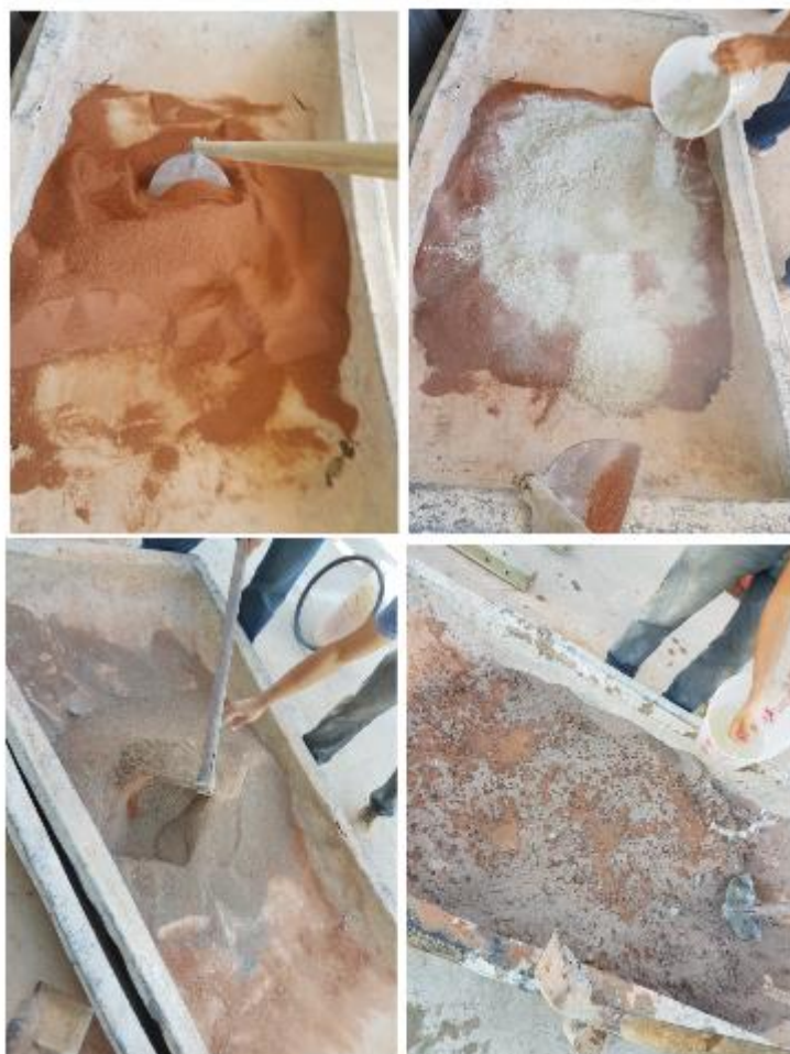
Figura 22: Sequência de preparação da mistura
