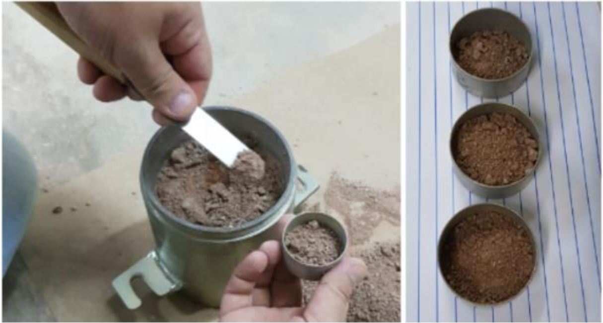
Figura 18:Retirada de amostras para determinação da umidade.
