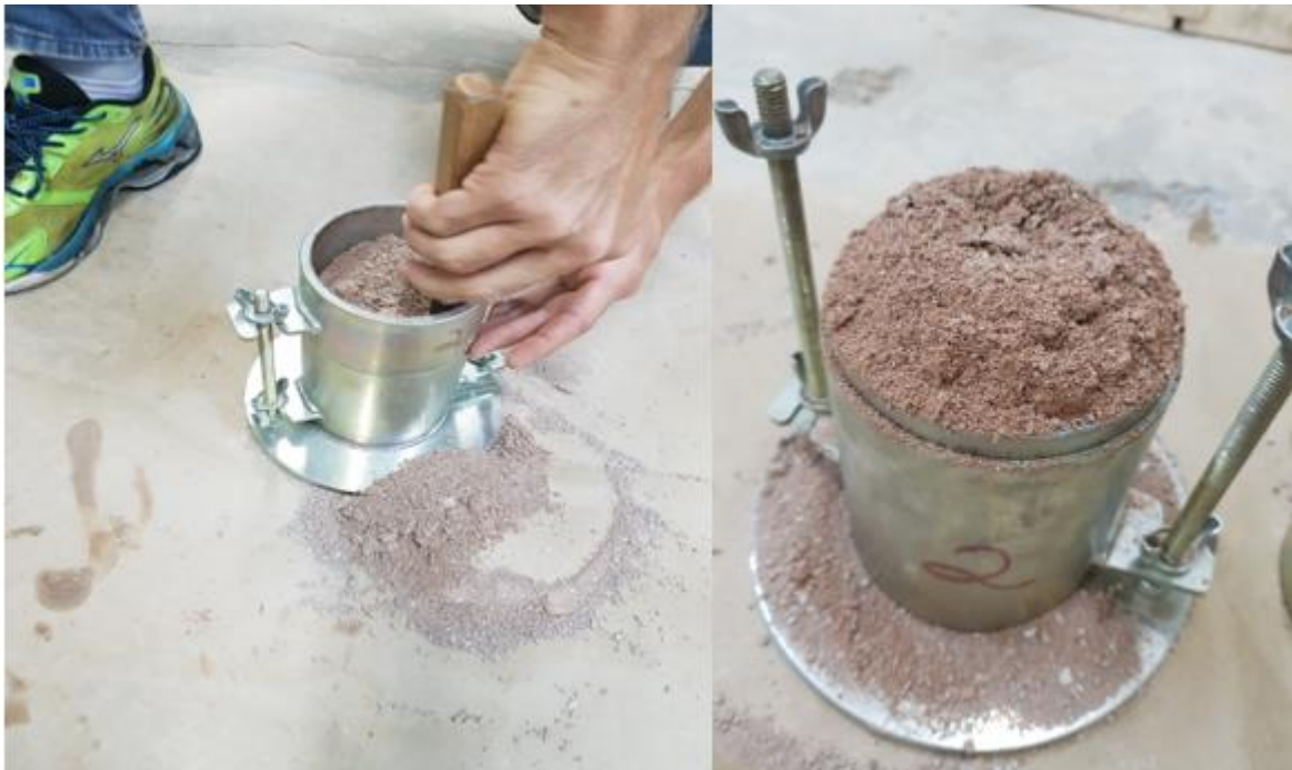
Figura 41: Retirada do colarinho, para finalização do procedimento.
