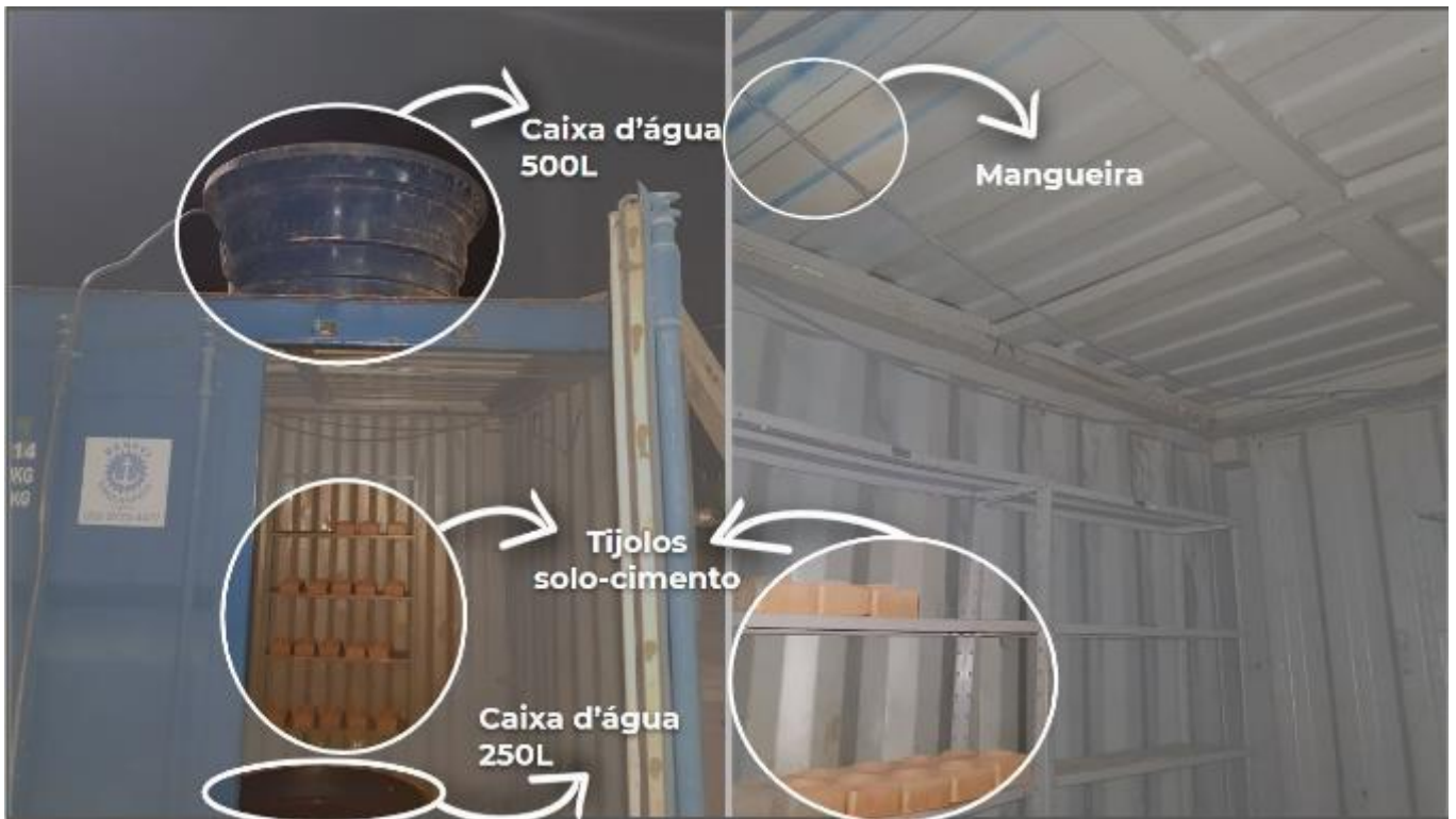
Figura 27: Container utilizado como câmara úmida
