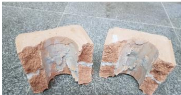
Figura 34: Corpo de prova rompido à compressão
