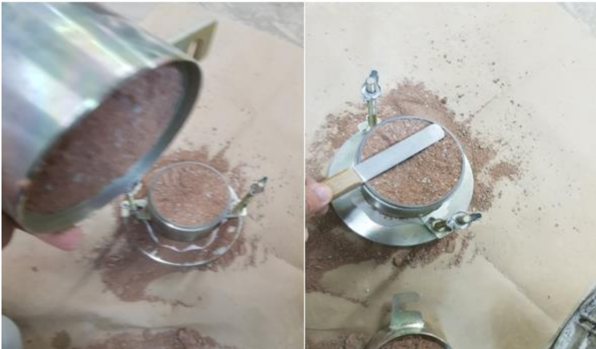
Figura 39: Falha na retirada do colarinho na mistura de solo-cimento
