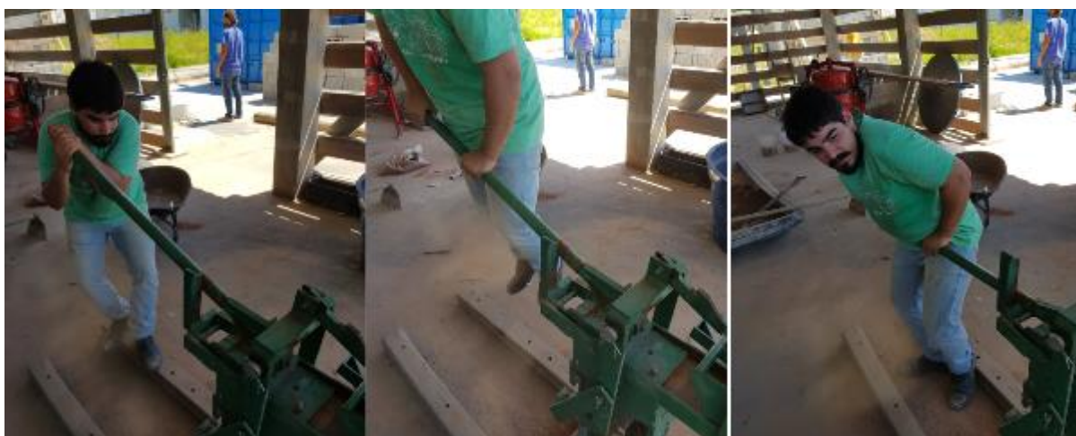
Figura 25: Processo de Prensagem do solo
