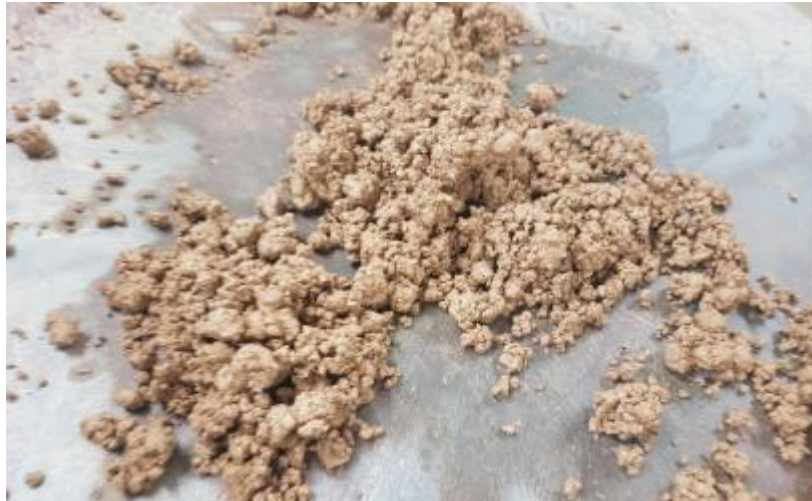
Figura 52: Mistura Solo 1 mais Solo 2 com 27,38% de umidade
