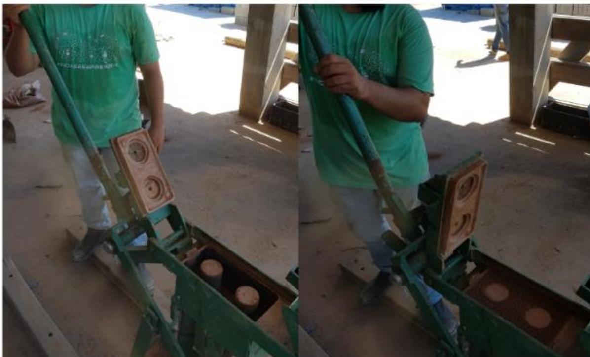
Figura 24: Abertura da prensa para colocação do solo
