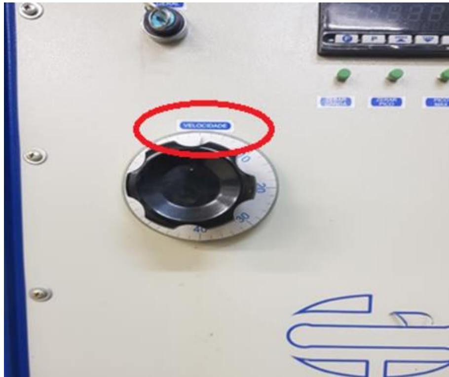
Figura 33: Painel da máquina de ensaio à compressão hidráulica, com destaque para a válvula que inicia o carregamento
