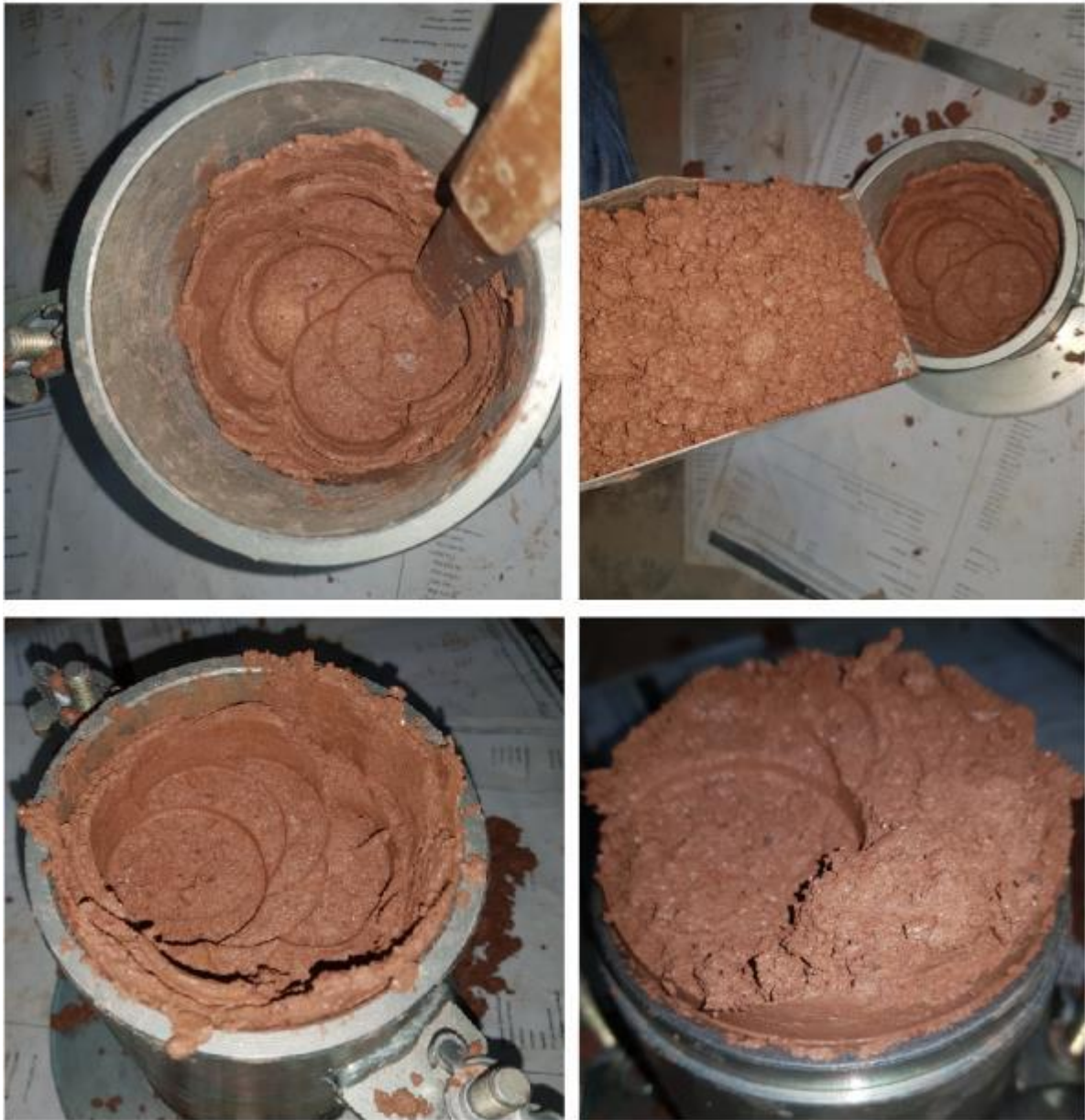
Figura 51: Ensaio Proctor Normal com 24,37% de umidade
