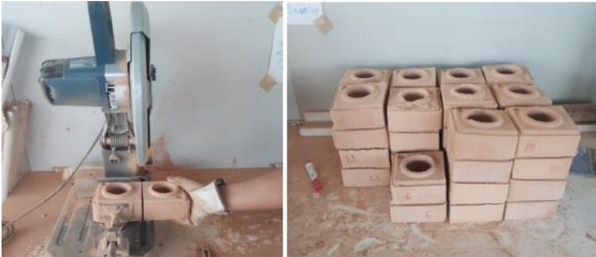
Figura 28: Corte dos corpos de prova utilizando uma serra policorte
