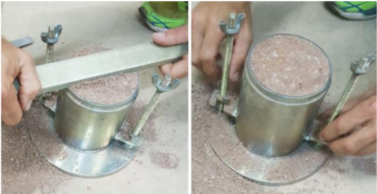
Figura 17: Arrasamento do solo em excesso.
