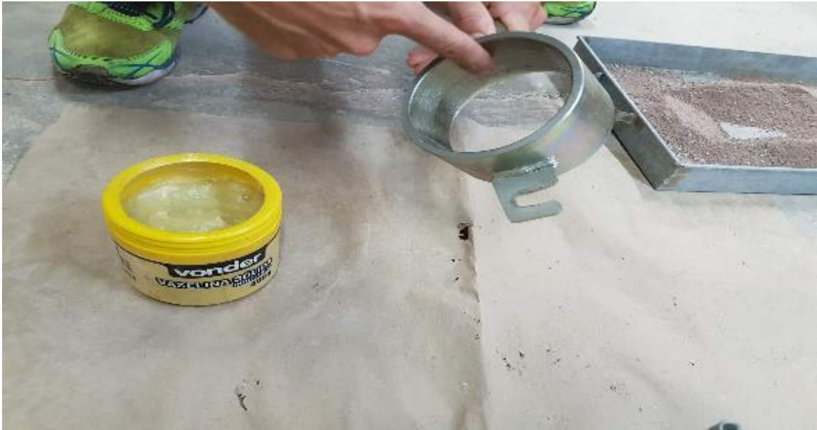
Figura 40: Lubrificação do colarinho com vaselina.
