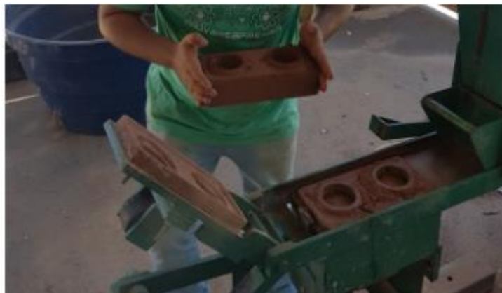
Figura 50: Tijolo retirado de forma errada
