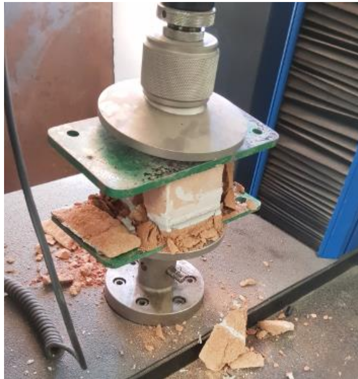
Figura 53: Tijolo rompido na máquina de ensaio à compressão "elétrica".
