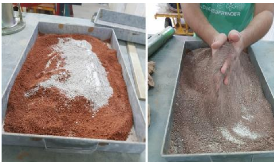
Figura 14: Processo de homogeneização da mistura
