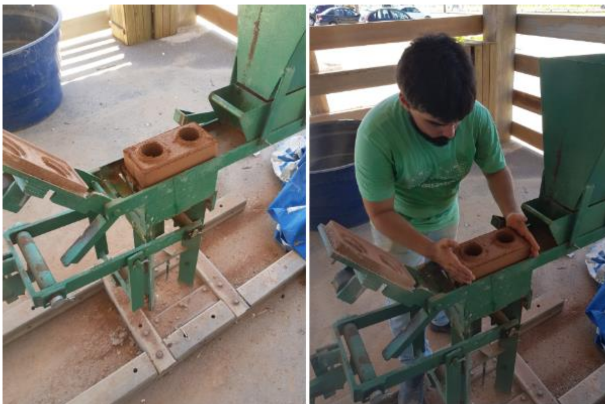
Figura 26: Etapa de desmoldagem do solo
