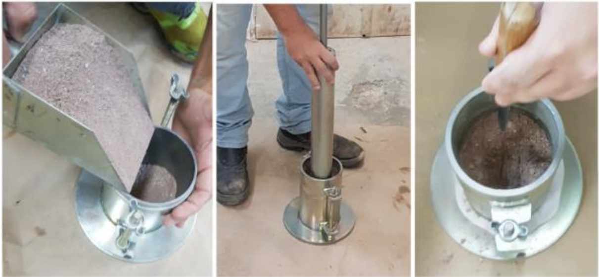
Figura 15: Preenchimento e compactação do molde.
