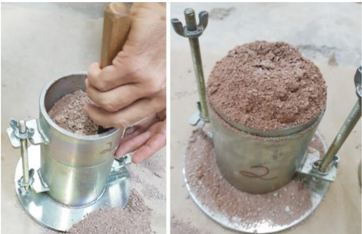
Figura 16: Escarificação da amostra
