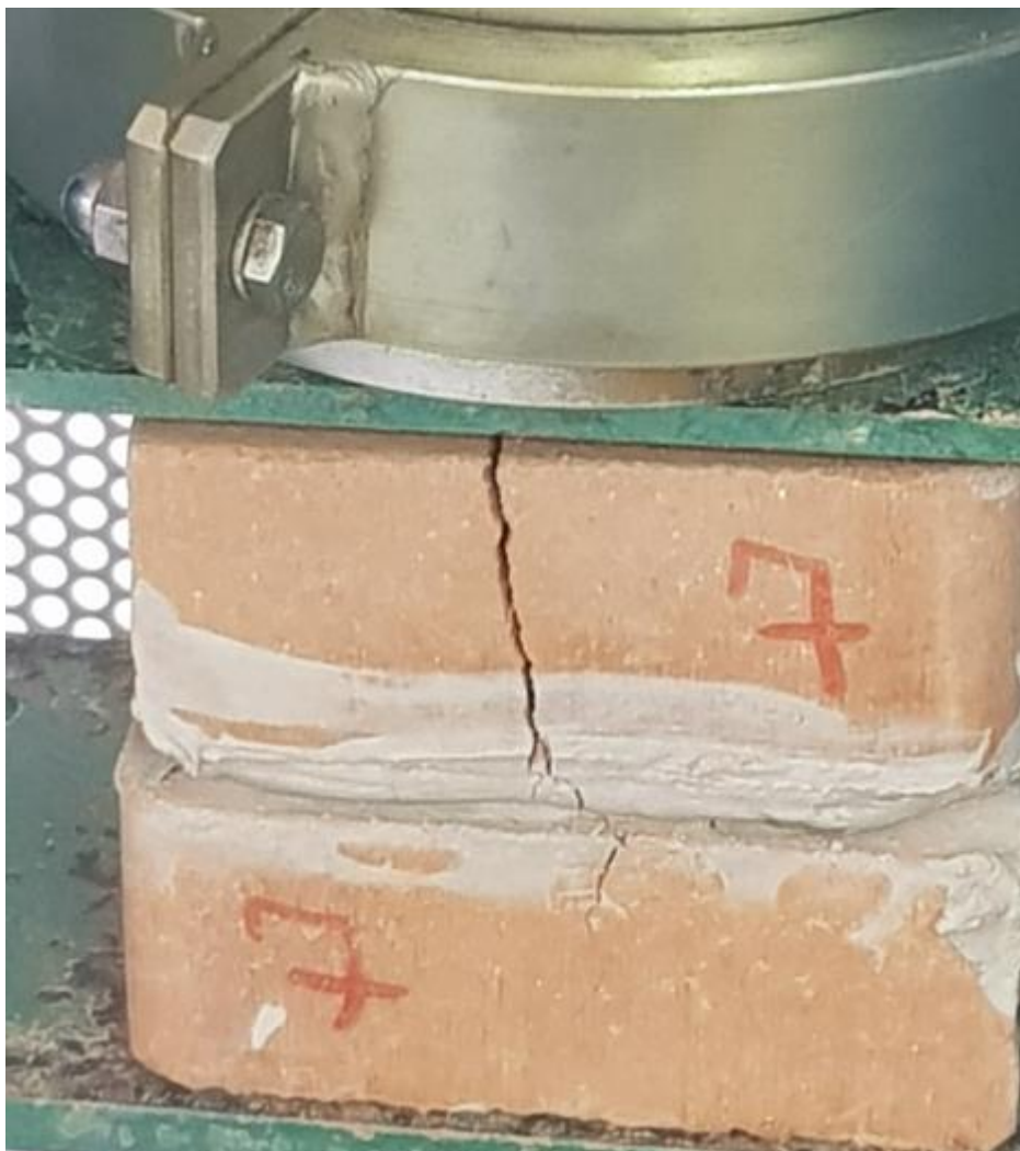
Figura 54: Tijolo rompido na máquina de ensaio à compressão "hidráulica"
