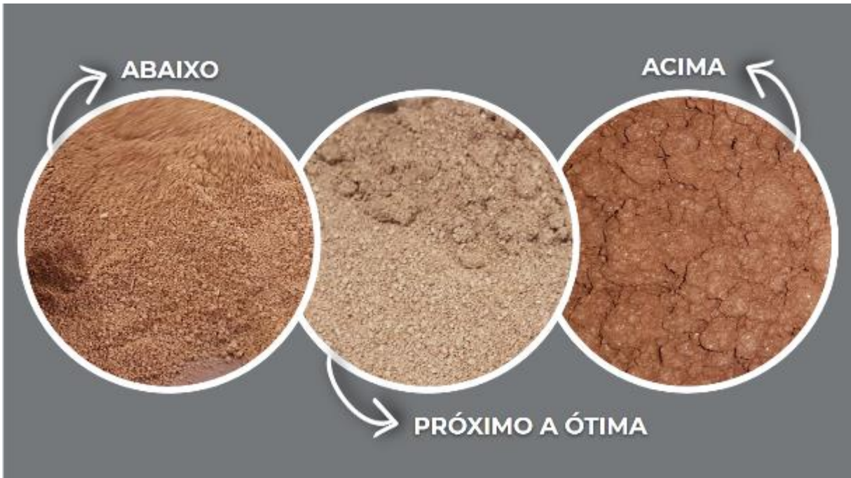
Figura 56: Solos com diferentes pontos de umidade
