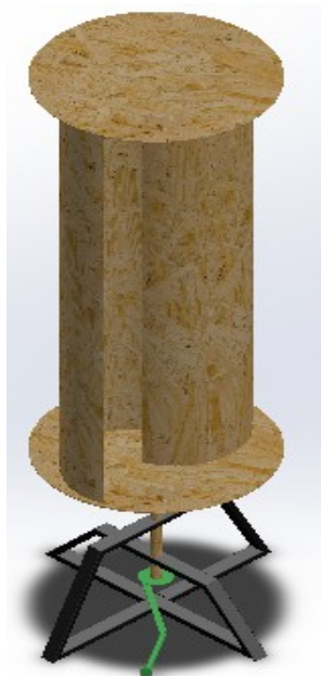
Figura 23: Vista isométrica do rotor Savonius com base de suporte (em preto) e mecanismo de transmissão (em verde).
