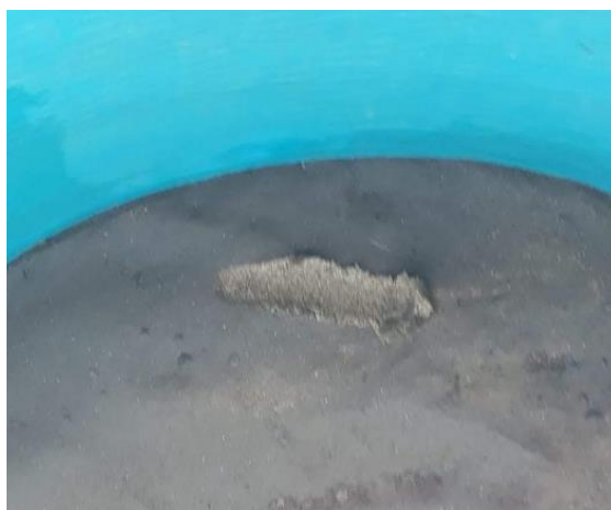
Figura 24: Início da formação da camada biológica, após 30 dias de operação, na segunda disposição das camadas do filtro (Fonte: Autora).
