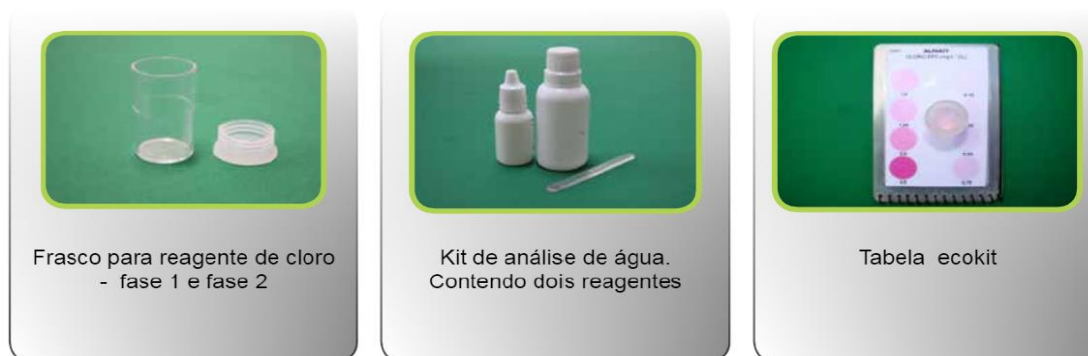
Figura 27: Kit para medir a quantidade de Cloro (EMBRAPA, 2014).
