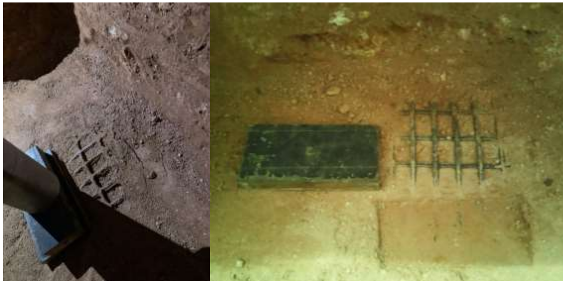
Figura 6.18 – Ruptura e recalque (ensaio 3).
