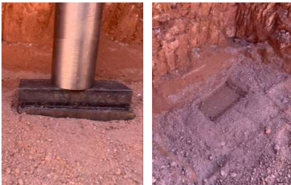
Figura 6.16 – Ruptura e recalque (ensaio 2).
