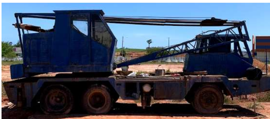
Figura 6.4 – Caminhão utilizado como sistema de reação.
