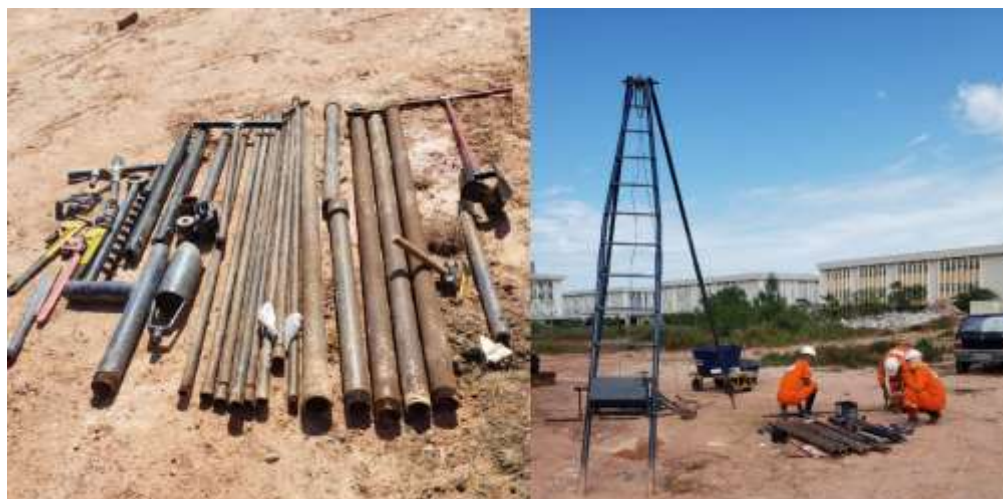
Figura 5.9 – Componentes da aparelhagem padrão e montagem do sistema.
