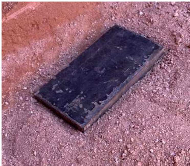
Figura 6.1 – Placa retangular rígida de aço (15cm x 8 cm x 2 cm).
