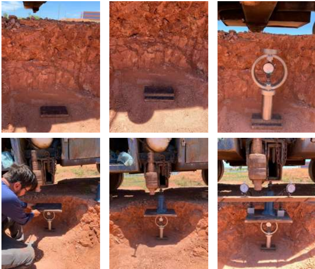
Figura 6.15 – Sequência de montagem dos equipamentos para execução do segundo ensaio.
