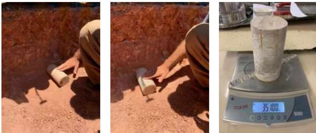
Figura 6.14 – Execução da compactação do solo usando o rolo compactador de 3,51 kg.
