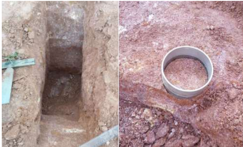
Figura 5.3 – Vala para coleta de amostra a 50 cm de profundidade e cravação do anel na superfície (Silva, 2019).
