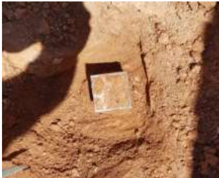
Figura 5.5 – Cravação do molde na superfície (Silva, 2019).
