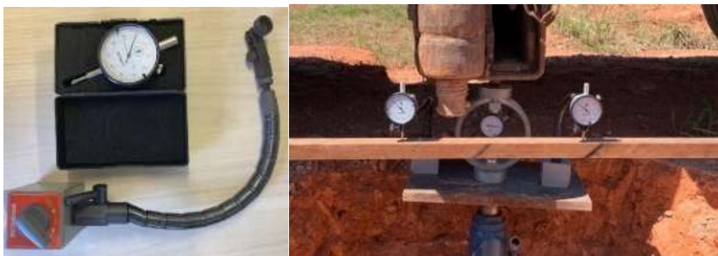
Figura 6.8 – Extensômetro, base magnética e viga de referência.
