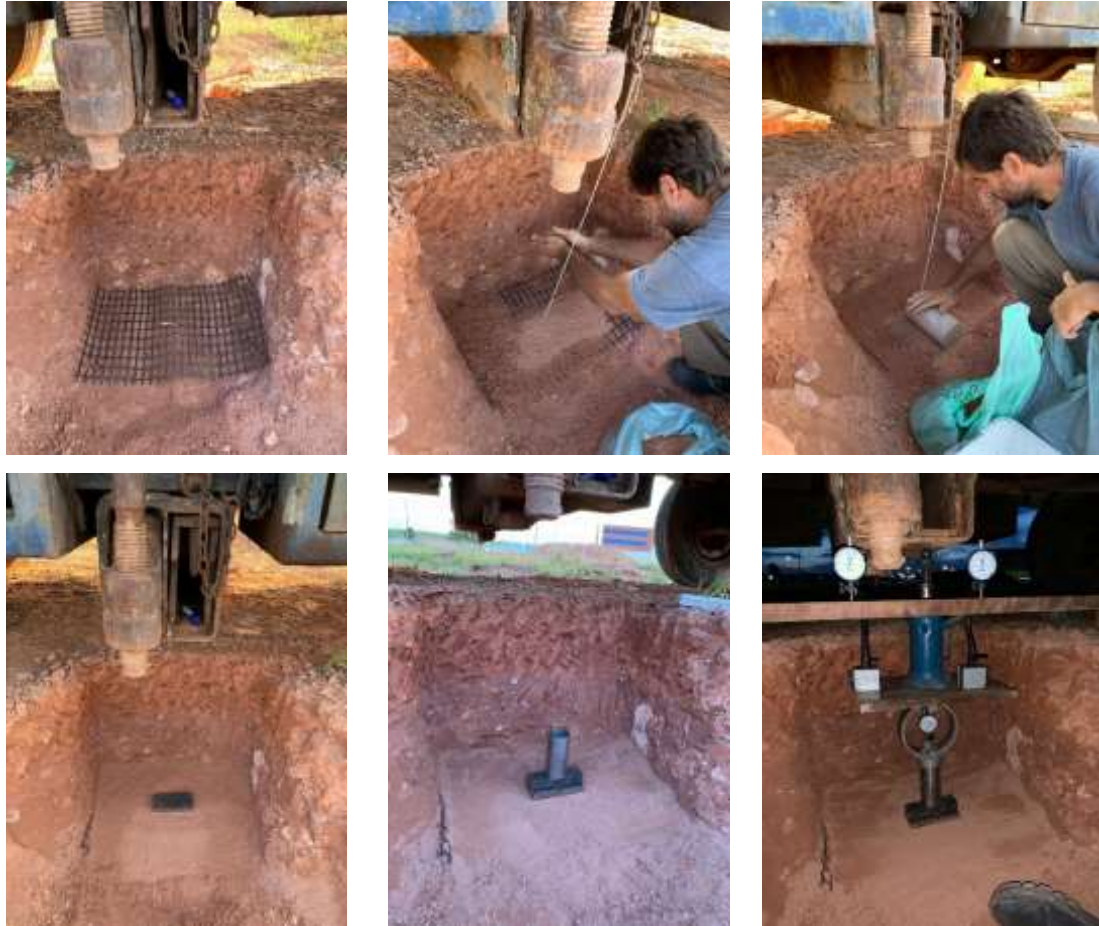
Figura 6.17 – Sequência de montagem dos equipamentos para execução do ensaio 3.
