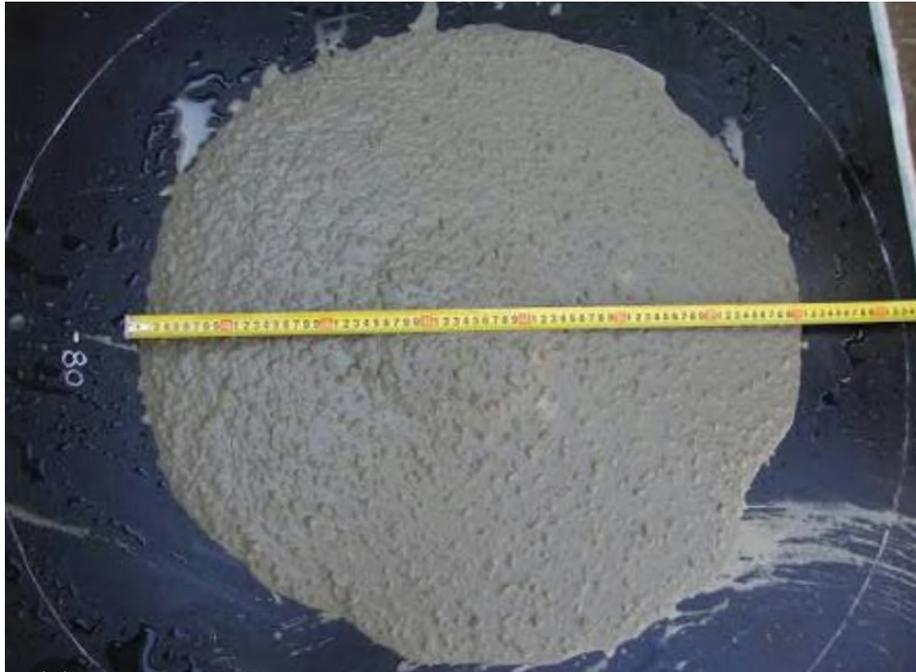
**Figura 38** - Representação do ensaio de *Slump Flow*.
