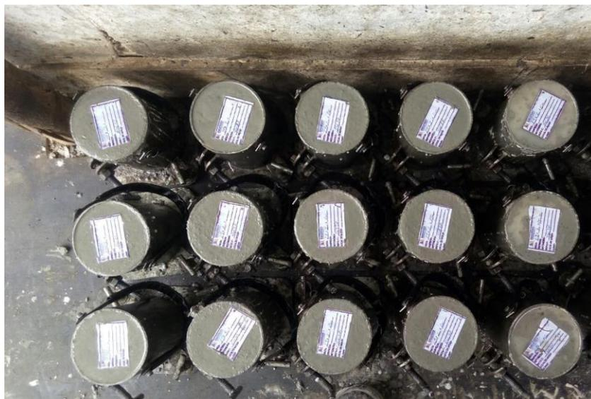
**Figura 40** – Corpos de prova.
