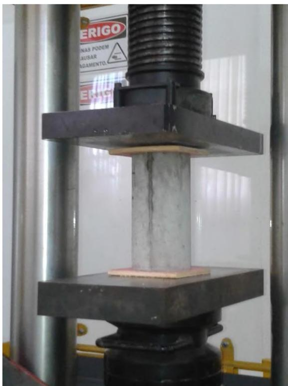
**Figura 41** – Ensaio de Compressão.
