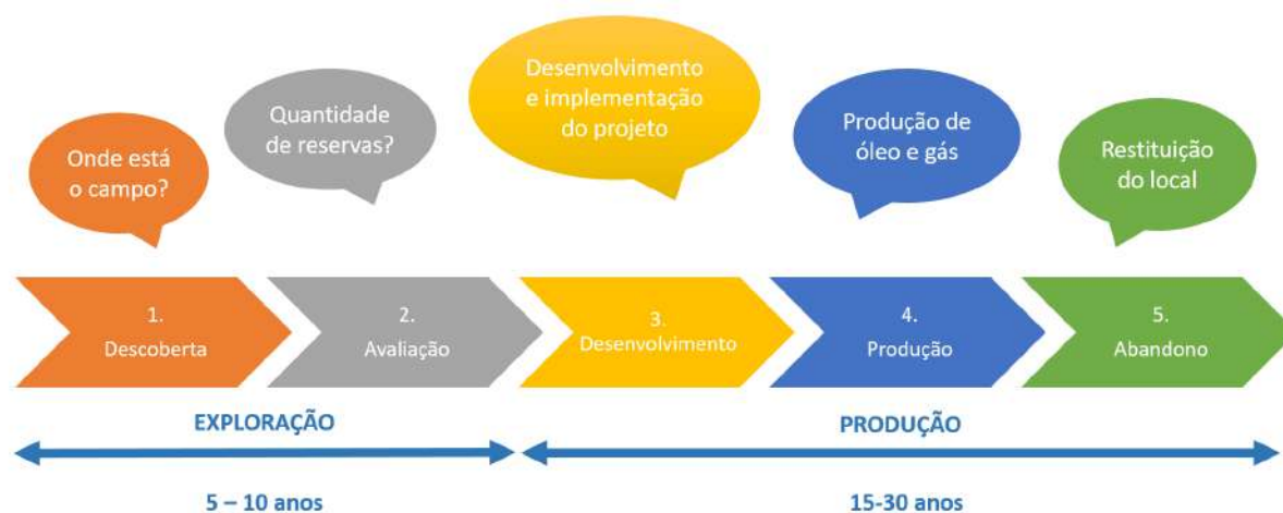
Figura 3 – Visão geral do processo de exploração e produção de petróleo offshore
