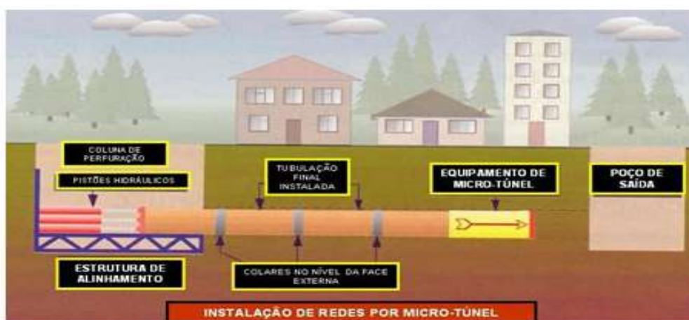
Figura 3.24 - Processo instalação de tubulação a partir de escavação com micro-túnel. Fonte: http://www.abratt.org.br/tecnologia/ (acessado em 07/07/2021).
