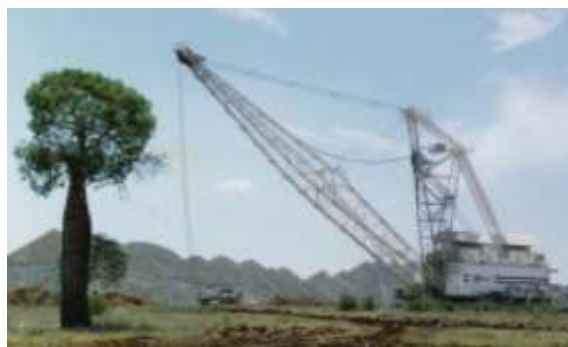
Figura 3.6 - Drag-line. Fonte: http://www.nolnacsmarine.com/draglines.html (acessado em 26/06/2021).
