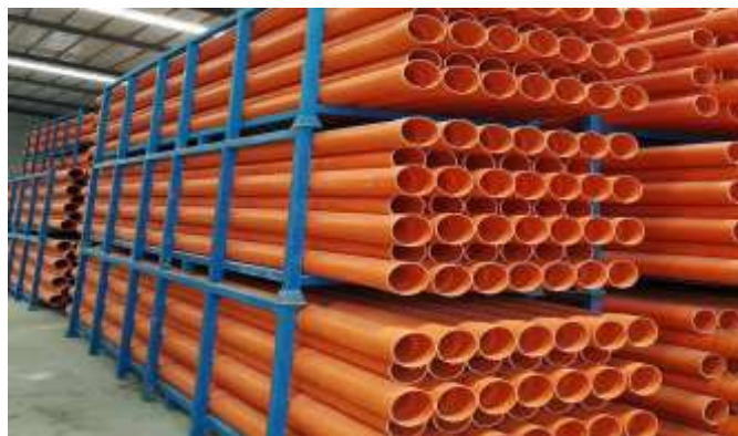
Figura 2.7 - Exemplos de armazenagem correta para tubos de PVC. Fonte: http://www.gxsby.com/gshj/26.html (acessado em 02/07/2021).
