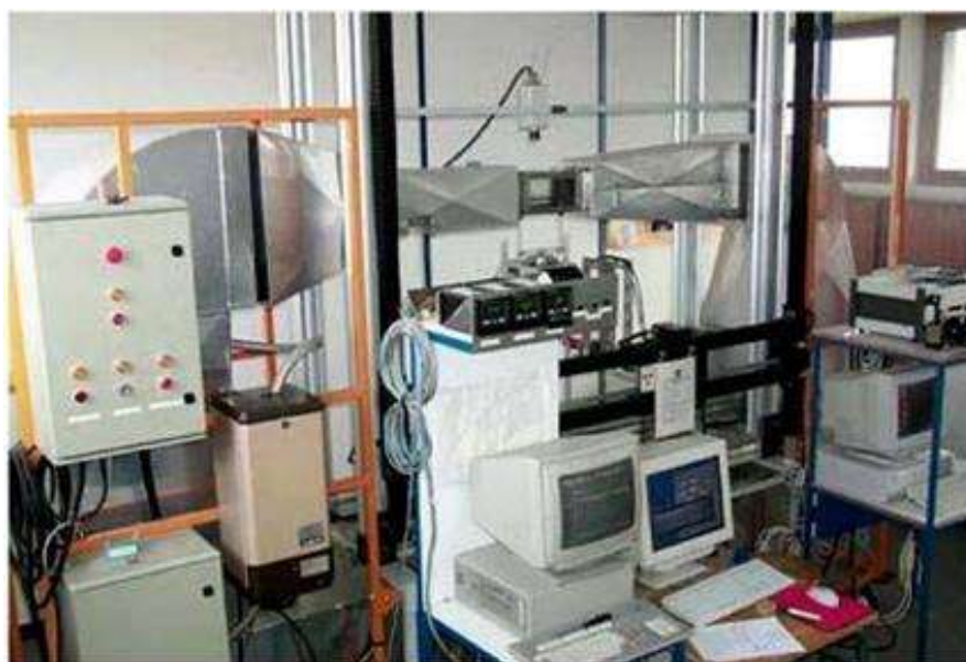
Figura 15: Secador convectivo do departamento do TREFLE.
