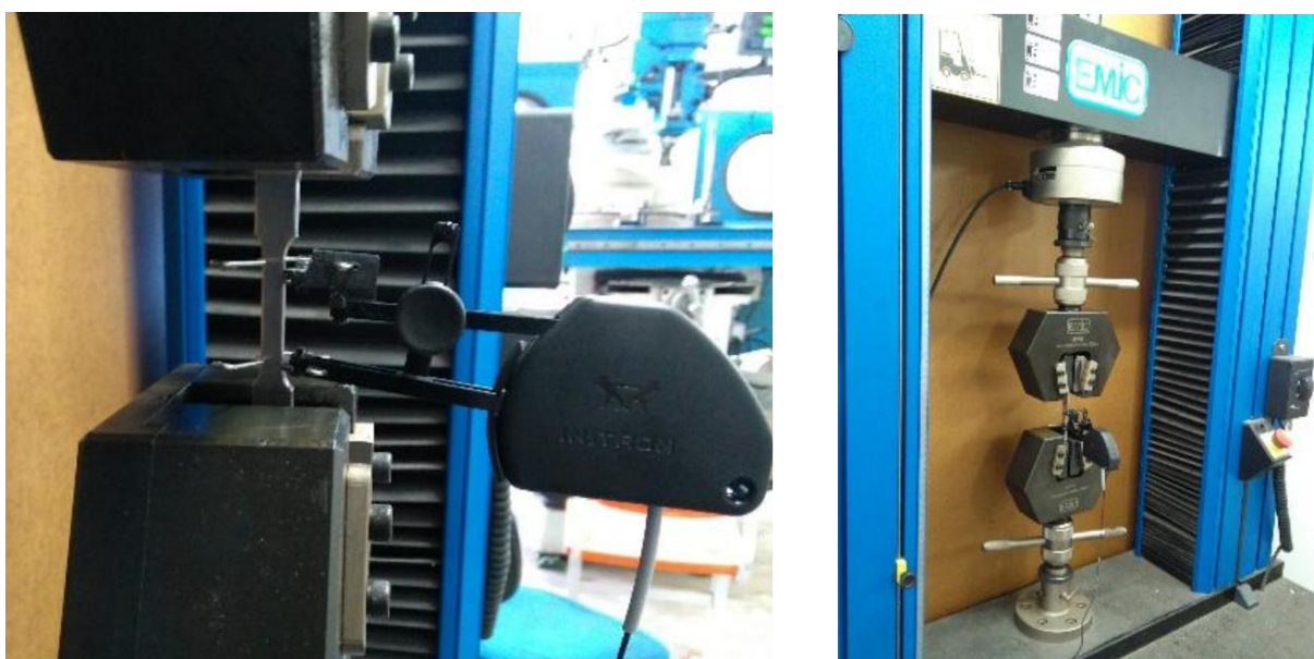
Figura 13: Esquema de montagem para ensaio de tração uniaxial.
