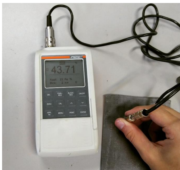
Figura 5: Medição da fração volumétrica de martensita com auxílio de um ferritoscópio.
