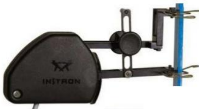
Figura 14: Extensômetro com base de medida 50mm. Adaptado http://www.instron.com.br .
