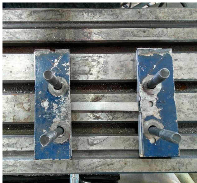
Figura 12: Montagem de suporte para usinagem de corpo de prova em fresadora.
