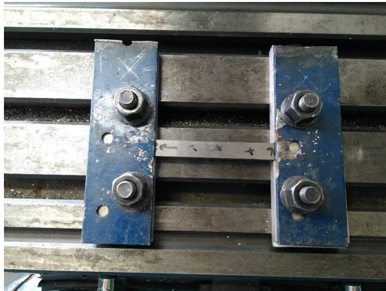
Figura 10: Detalhe do assessorio para fixação do corpo de prova na mesa da fresadora.
