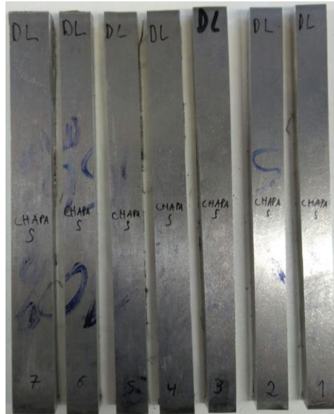
Figura 7: Chapa cortada na orientação 0^\circ em relação a direção de laminação.
