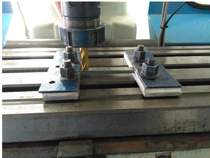
Figura 8: Arranjo fresadora-ferramenta-corpo de prova para execução de fresamento.
