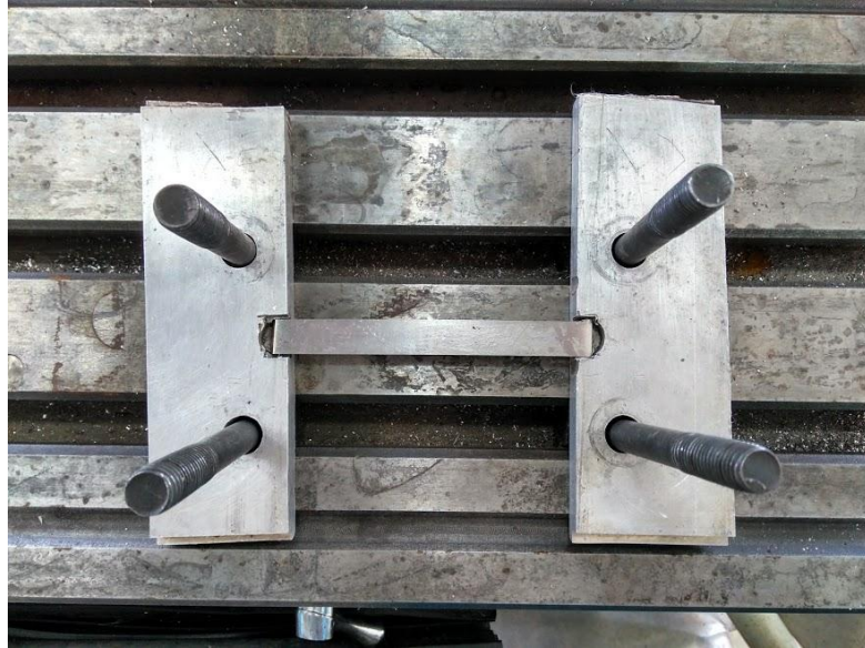
Figura 11: Esquema de fixação de corpo de prova para usinagem em fresadora.
