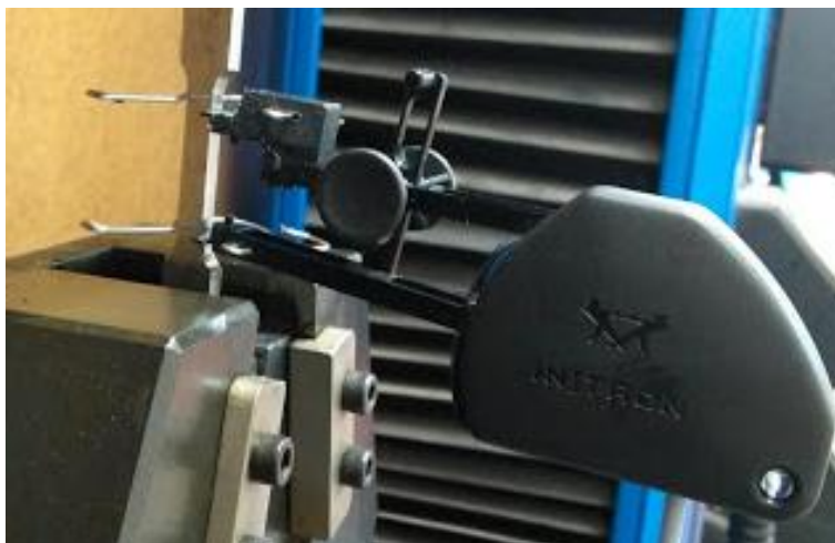
Figura 15: Extensômetro com nova base de medida de 25mm.
