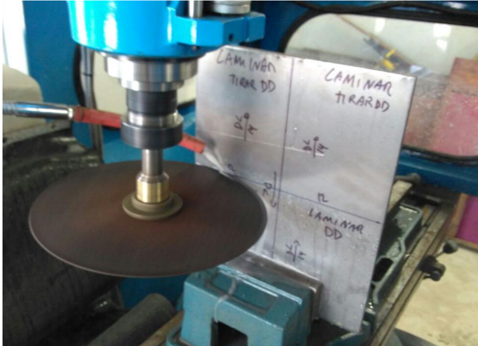
Figura 3: Execução do corte das chapas de aço inoxidável 304 utilizando fresadora e disco de corte metalográfico.
