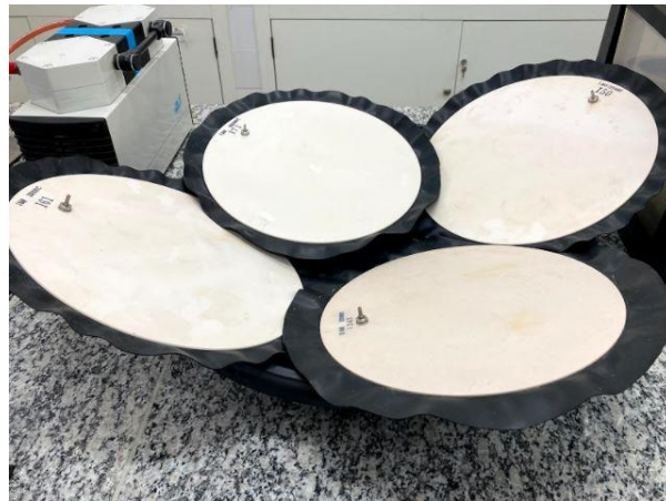
Figura 3.15 – Placa cerâmica porosa utilizada dentro da câmara de Richards.
