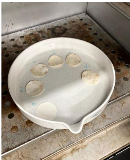
Figura 3.10 – Papel filtro na estufa por um dia.
