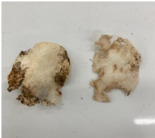
Figura 3.6 – Papel filtro deteriorado referente ao primeiro ensaio realizado.
