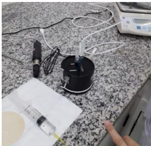
Figura 3.19 - Mini tensiômetro saturado acoplado a unidade sensora para realização do ensaio.
