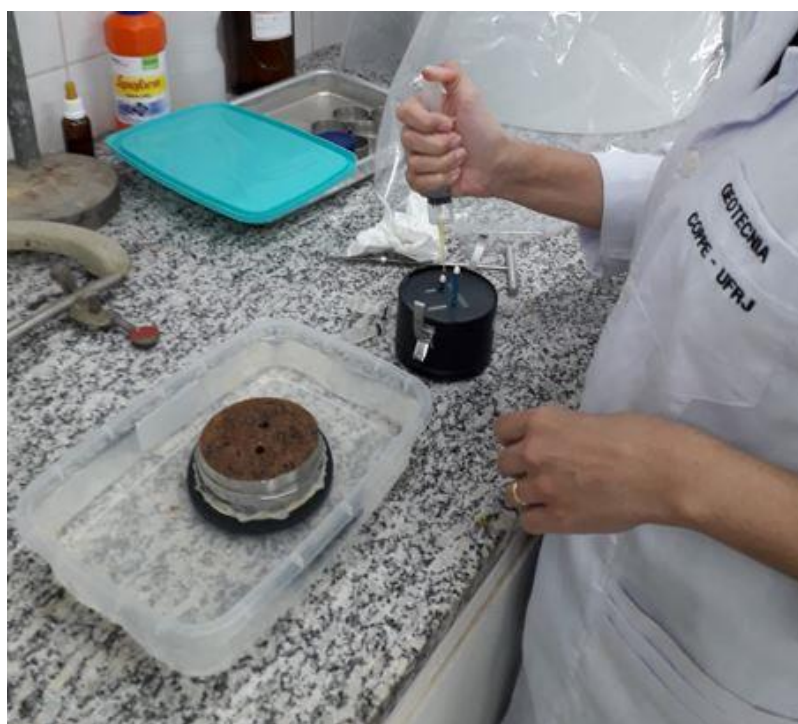
Figura 3.22 – Manutenção da saturação do tensiômetro durante todo o processo de realização do ensaio.
