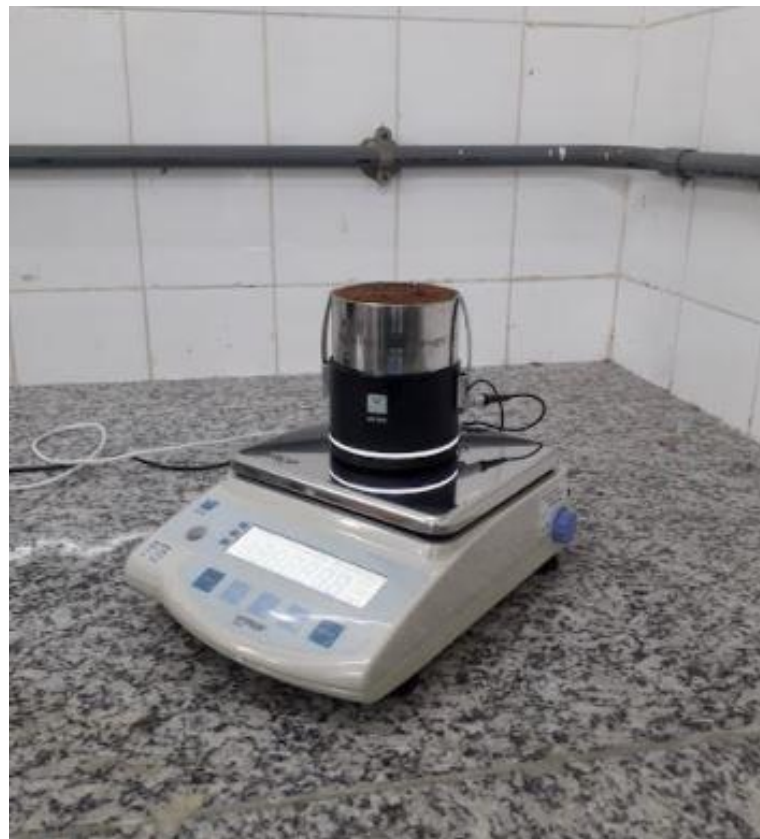
Figura 3.24 – Realização do ensaio de evaporação pelo analisador HYPROP®.
