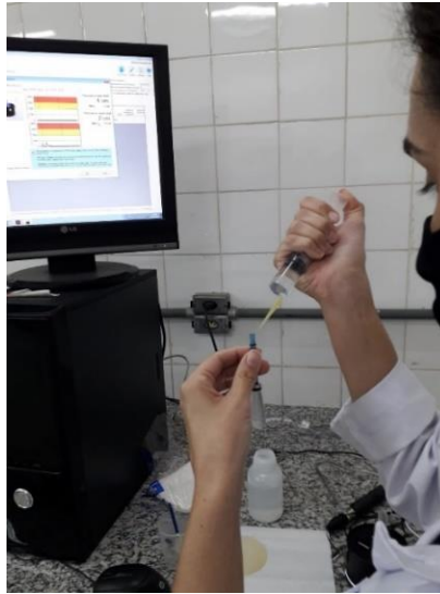
Figura 3.18 - Mini tensiômetro já saturado com água deionizada e desaerada, em bomba a vácuo por 24 horas, com sucções de 5 minutos cada hora.
