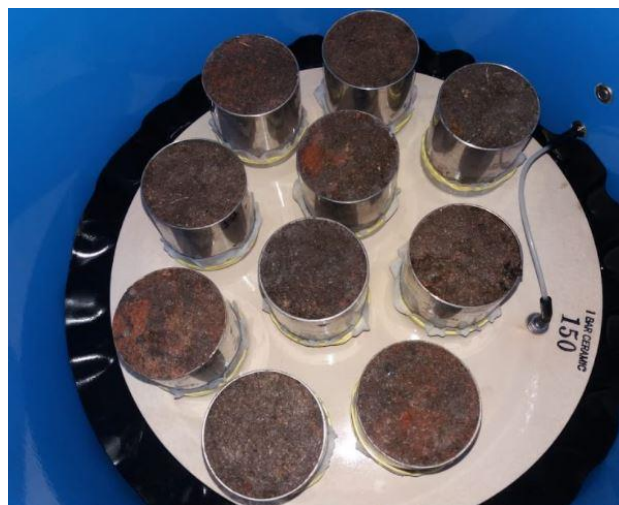
Figura 3.16 – Amostras saturadas sobre a placa porosa para realização do ensaio.
