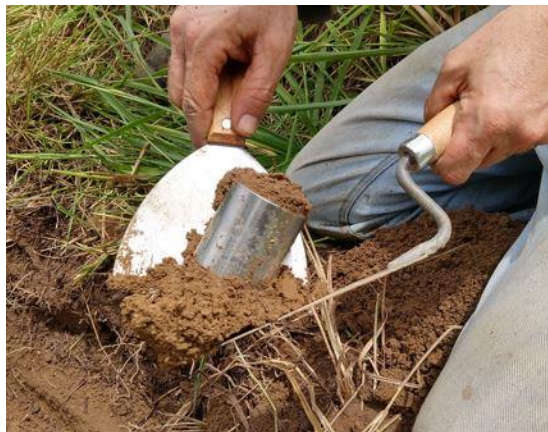
Figura 3.2 - Coleta da amostra indeformada do solo.
