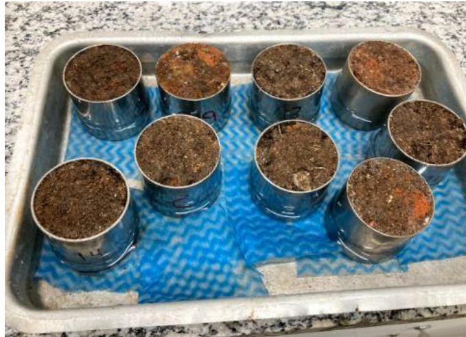
Figura 3.14 – Amostras sendo saturadas por elevação gradual.
