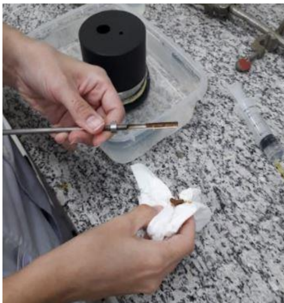
Figura 3.21 – Mini-trado para furar a amostra para inserção dos mini-tensiômetros.
