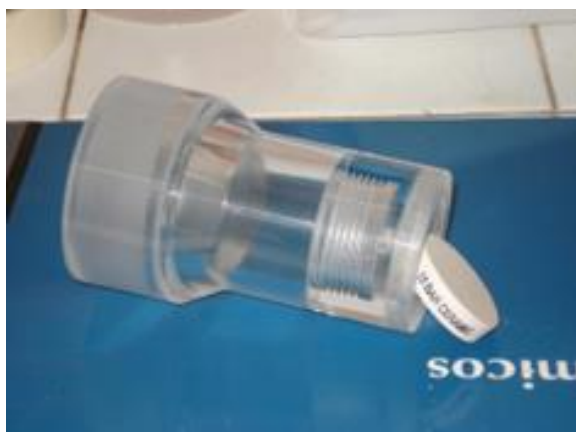
Figura 2.9 - Corpo acrílico e pedra cerâmica porosa de 15 bar (Nacinovic, 2009).
