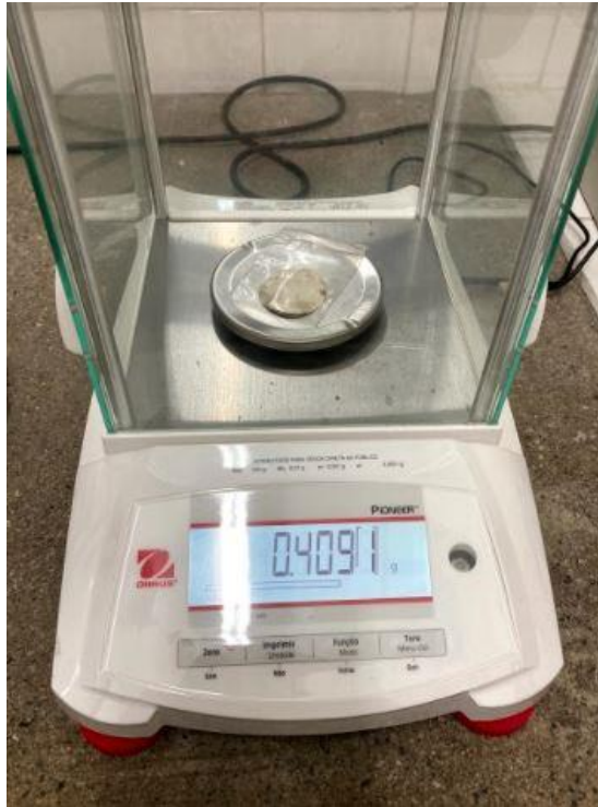
Figura 3.8 – Plástico zipado com papel filtro sendo pesado na balança de precisão.
