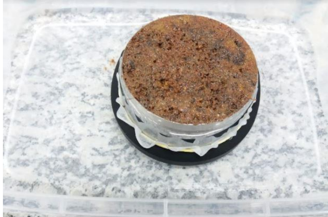
Figura 3.17 - Amostra de solo indeformado sendo saturada para a realização do ensaio.
