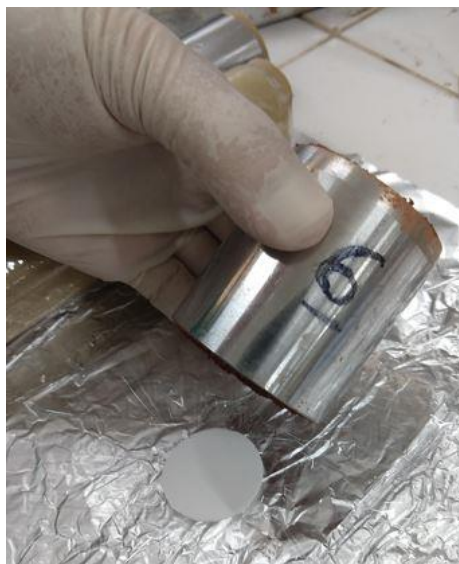
Figura 3.7 – Disposição dos três papéis filtro na amostra do solo.
