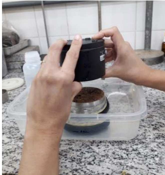
Figura 3.23 – Instalando a amostra na base sensora.
