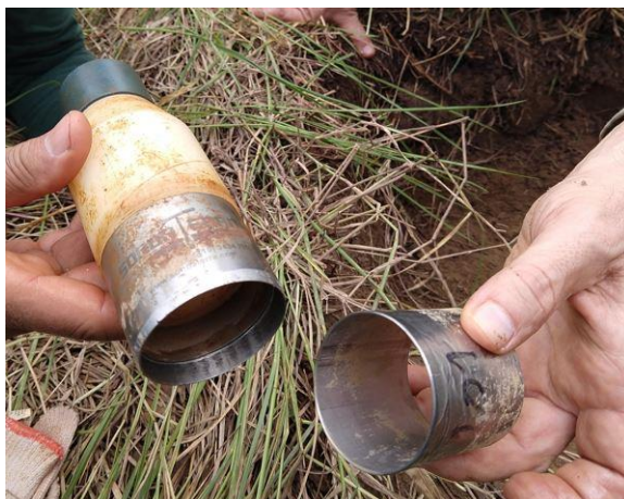
Figura 3.4 - Corte em bisel nos anéis para auxiliar na coleta das amostras.
