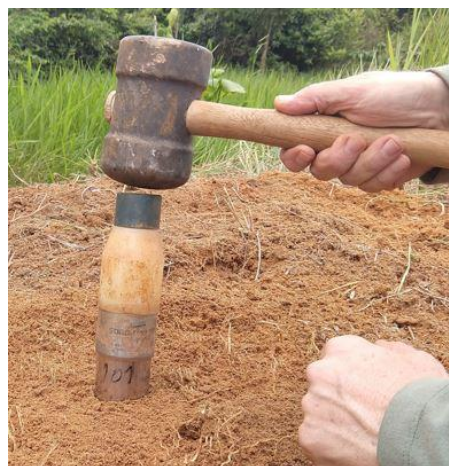
Figura 3.3 - Amostragem do solo com martelo de borracha.
