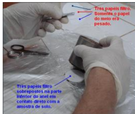
Figura 2.14 - Representação de ensaio Papel Filtro (Nacinovic, 2009).
