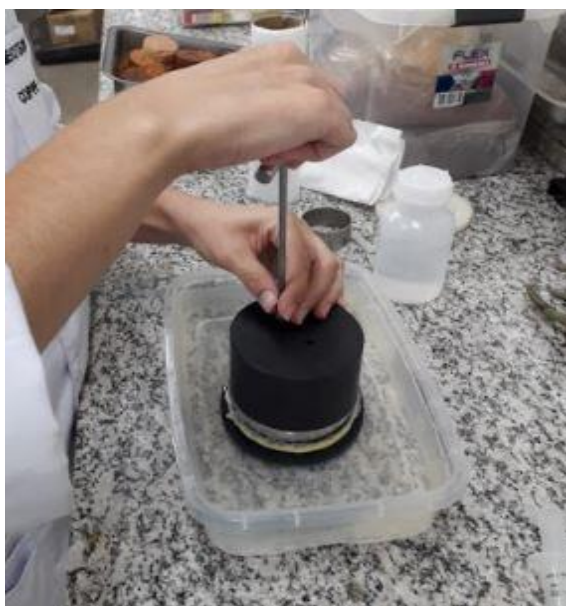
Figura 3.20 – Realização de furos na amostra para inserir dois mini-tensiômetros.
