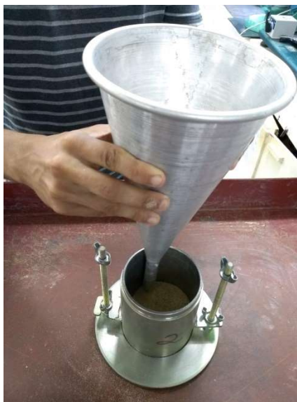
Figura 4.7 - Procedimento de pluviação com funil durante a execução do Método “A” da ASTM adaptado.
