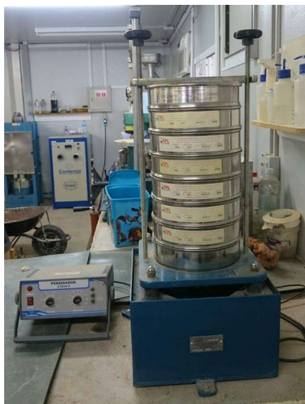
Figura 3.1: Conjunto de peneiras utilizadas na granulometria sobre agitador mecânico.
