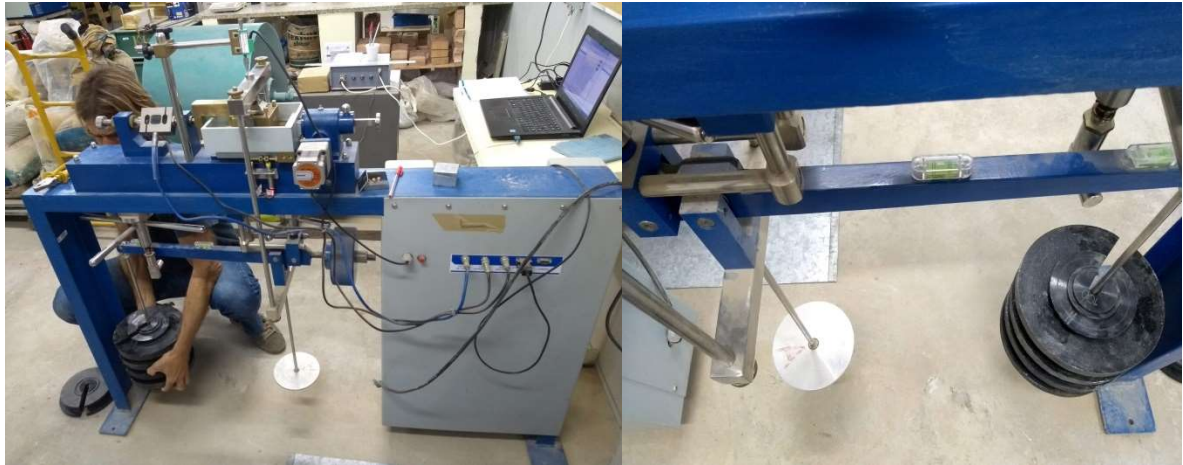
Figura 6.6: Execução do ensaio com tensão de adensamento de 1600 kPa (esquerda) e braço de alavanca devidamente nivelado (direita).
