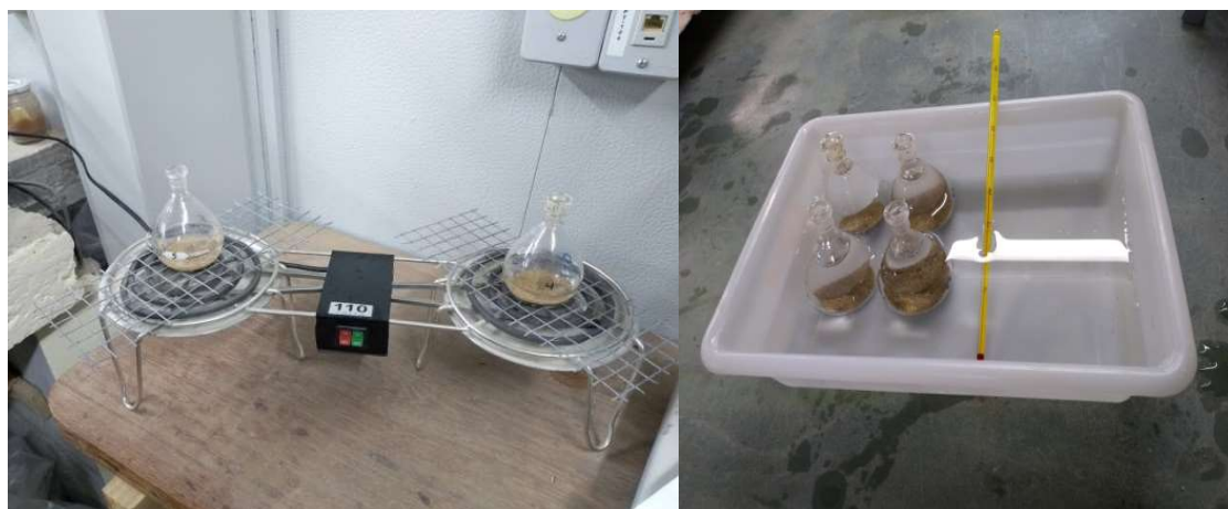
Figura 3.15 - Picnômetros sendo aquecidos na chapa elétrica (esquerda) e picnômetros dispostos no recipiente com água (direita).
