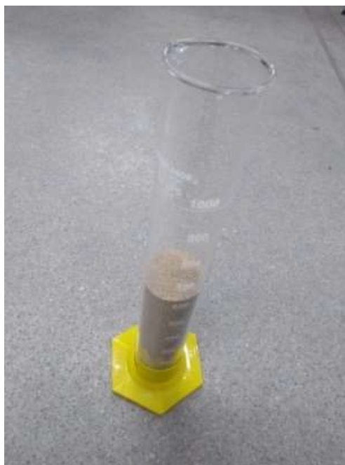
Figura 4.9 - Proveta graduada com areia, empregada no Método “C” da ASTM adaptado.
