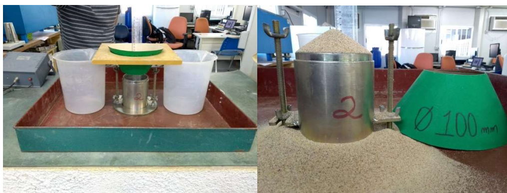
Figura 4.6 - Equipamentos utilizados no método de pluviação sobre o molde antes (esquerda) e depois do ensaio (direita).
