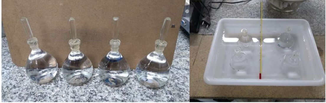
Figura 3.16 - Pícnômetros completamente preenchidos com água destilada (esquerda) e pícnômetros colocados em banho no recipiente com água (direita).
