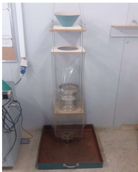
Figura 6.3: Equipamento de pluviação com a caixa de cisalhamento.
