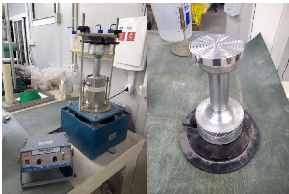
Figura 4.5 - Conjunto molde e sobrecarga disposto no agitador de peneiras para execução do método Geolabs adaptado (esquerda) e sobrecarga utilizada (direita).
